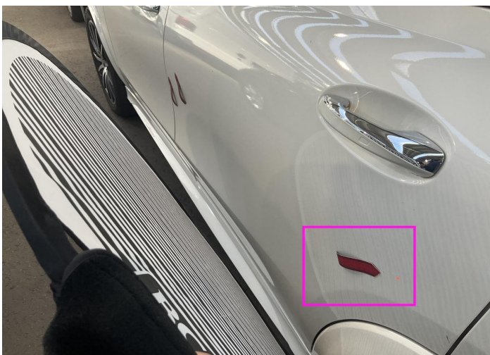
8. Door / Back Left Bodywork / Dent / Dent -
