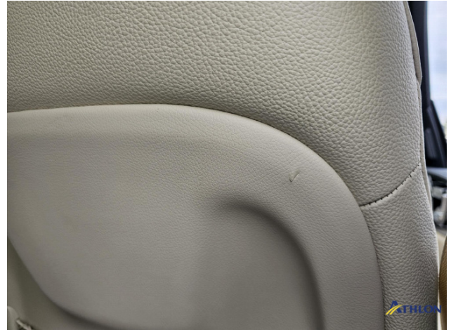
12. Sitz - Vorne - Rechts: Lehne Beschädigt
