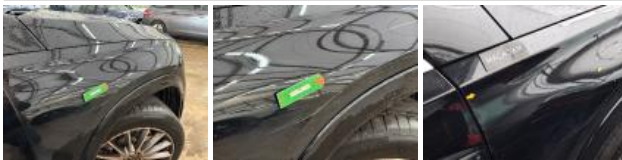
Aile AVD, Mauvaise réparation, Peindre
