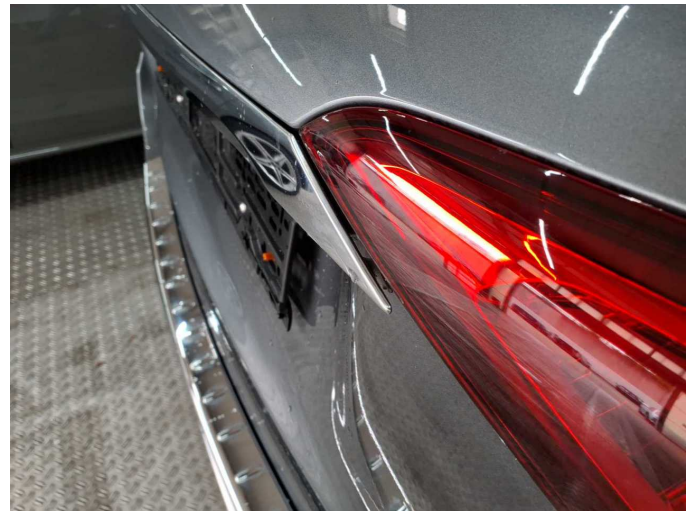
Damage 2: Boot lid / rear door: Boot lid (Zierleiste, Klebefestigung lose) - Unprofessionally repaired - Replace
