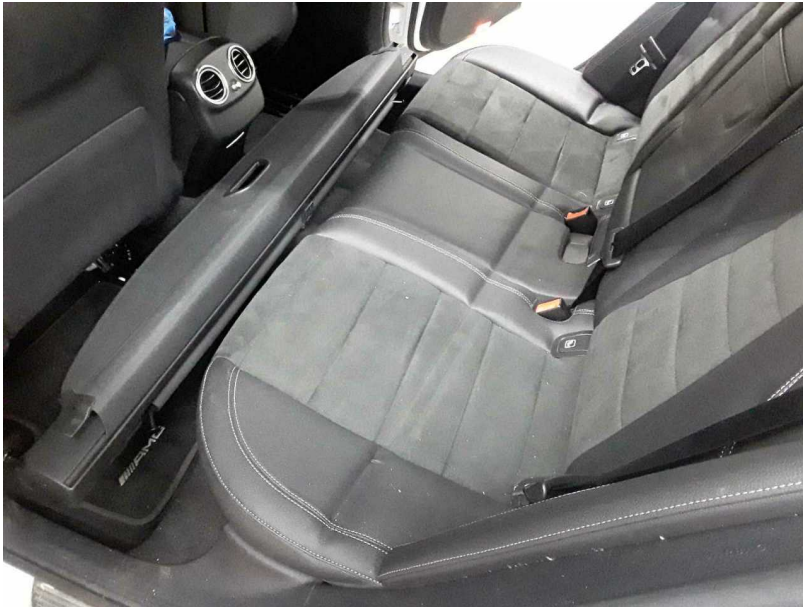
Beschädigung #9: Sitz hinten: Sitzpolster 3er Sitzbank (und -bezug) - verformt - erneuern
