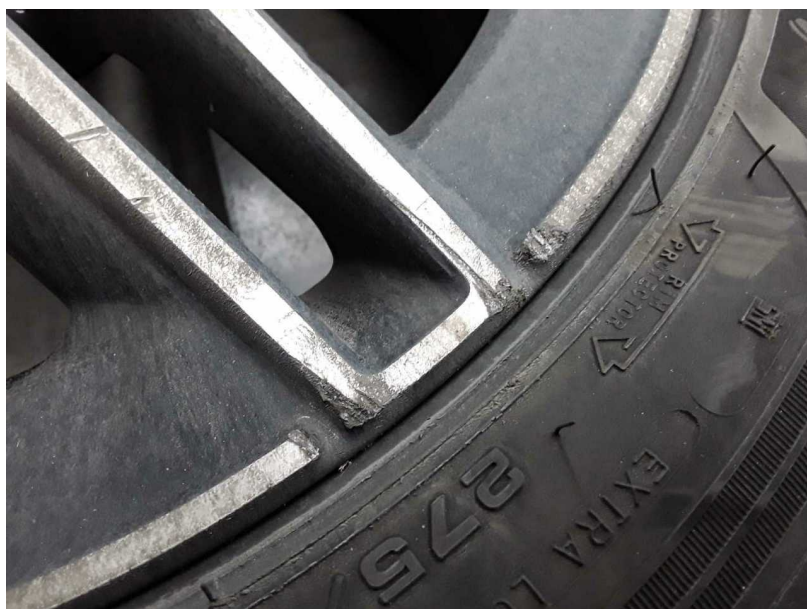
Beschädigung #12: 2.Radsatz: 3 Leichtmetallfelgen - beschädigt - erneuern
