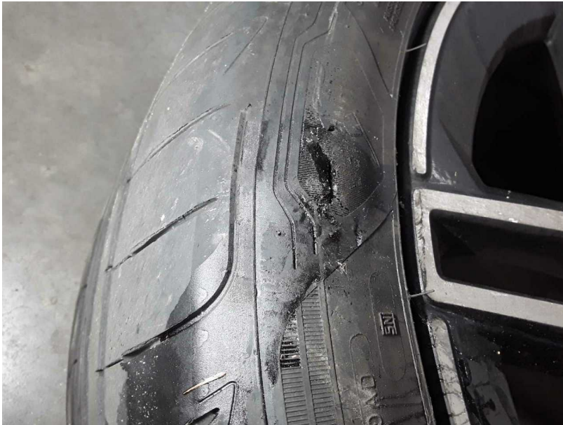
Beschädigung #7: 2.Radsatz: 2 Reifen - beschädigt - erneuern
