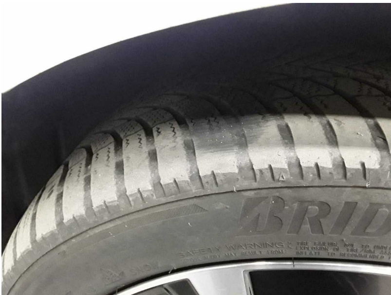
Beschädigung #1: Rad/Reifen: Reifen vorn - verschlissen - kein Abzug
