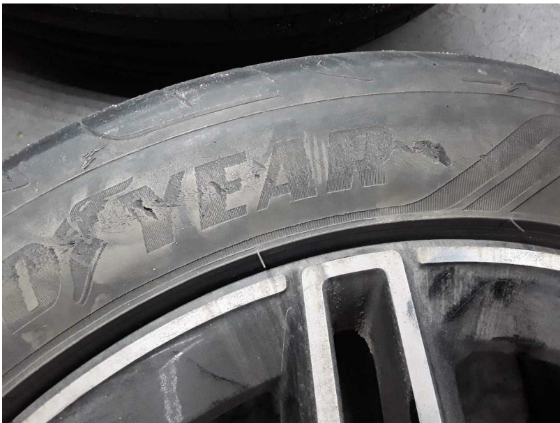
Beschädigung #7: 2.Radsatz: 2 Reifen - beschädigt - erneuern
