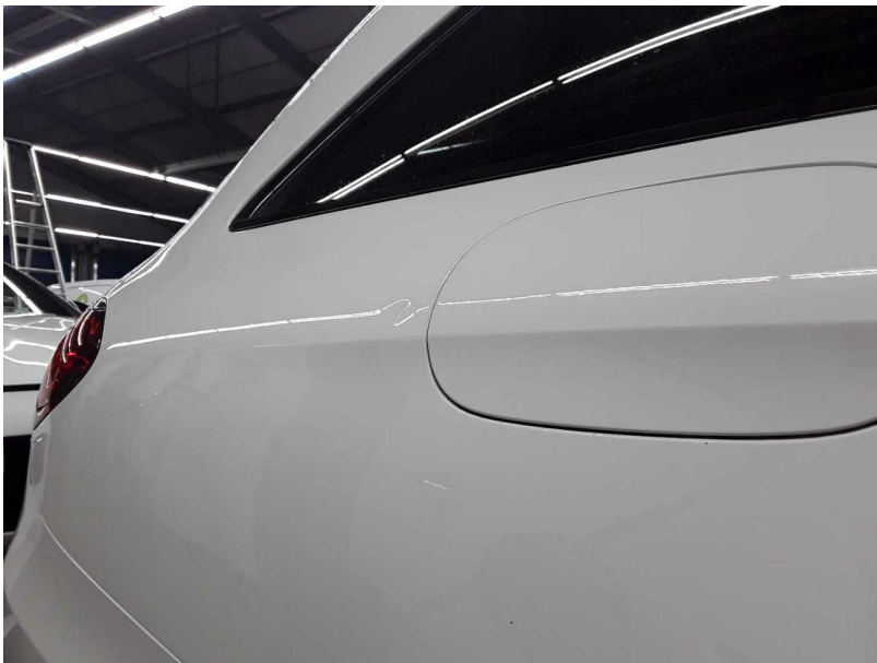
Beschädigung #4: Seitenwand rechts: Seitenwand - Delle(n) - Smart Repair
