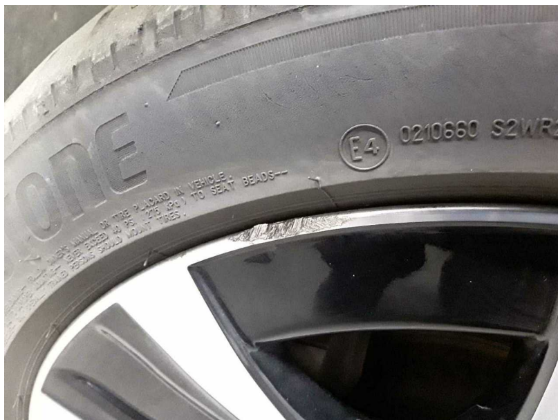
Beschädigung #11: Rad/Reifen: Leichtmetallfelge vorn rechts - beschädigt - erneuern
