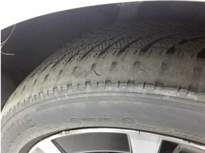
Beschädigung #1: Rad/Reifen: Reifen vorn - verschlissen - kein Abzug
