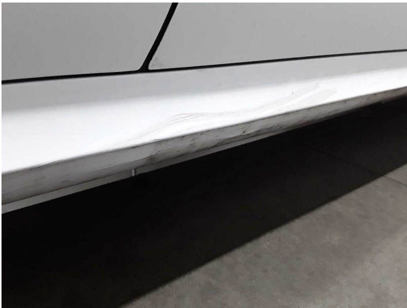
Beschädigung #10: Schweller rechts: Verkleidung - verformt - erneuern
