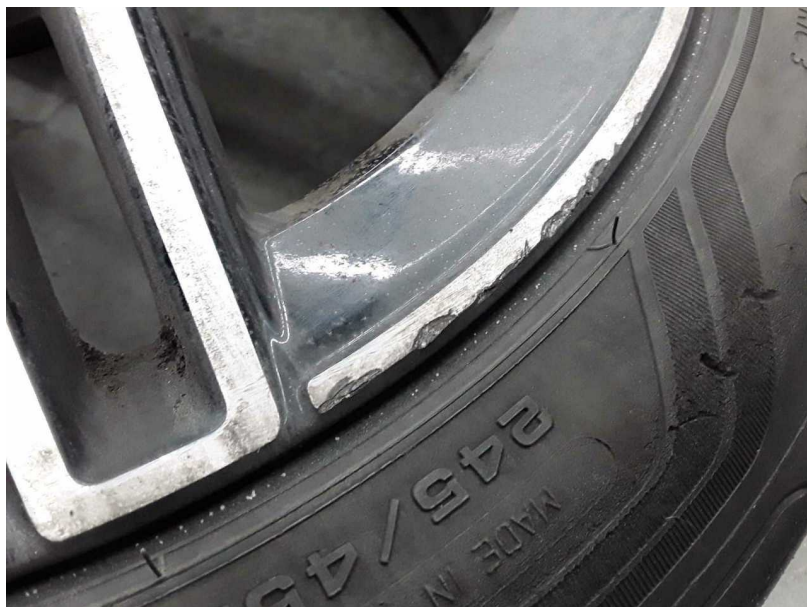
Beschädigung #12: 2.Radsatz: 3 Leichtmetallfelgen - beschädigt - erneuern
