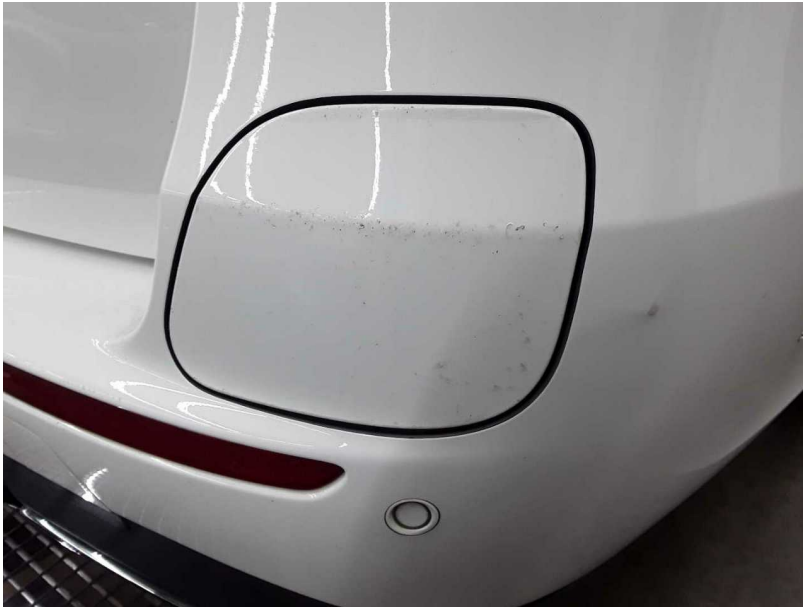
Beschädigung #5: Stossfänger hinten: Stossfänger mit Parktronic - Kratzer - lackieren
