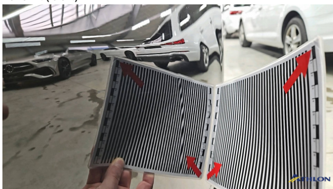
6. Stoßfänger Hinten Verformt (leicht)
