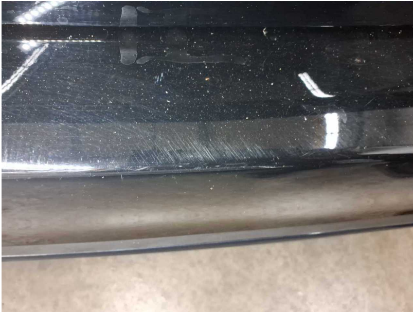
Beschädigung #4: Karosserie: Karosserie - Lackmangel - Wertminderung
