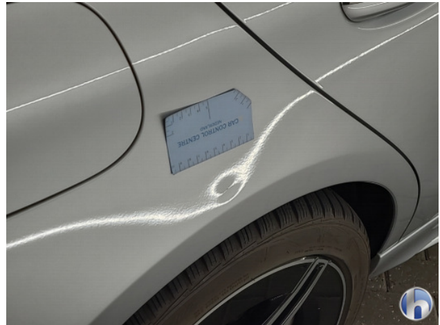
1. Zijwand - achter - rechts Deuk/deuken - Herstellen zonder spuiten
