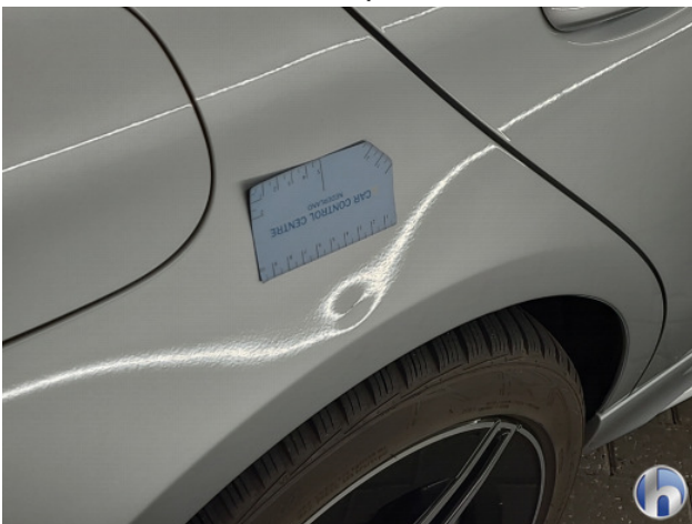
1. Zijwand - achter - rechts Deuk/deuken - Herstellen zonder spuiten
