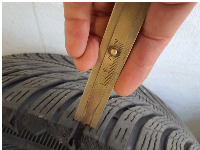
Beschädigung 4: 2.Radsatz: 2 Reifen - verschlissen - erneuern
