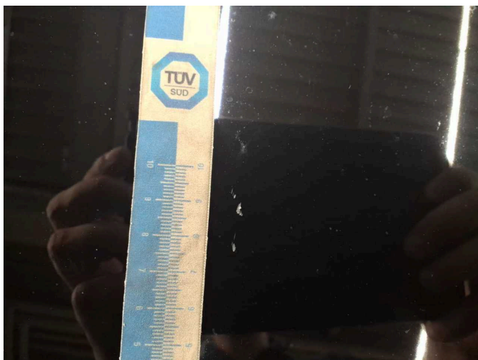
Beschädigung 1: Motorhaube: Motorhaube - Steinschlag - lackieren
