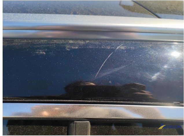
6. telaio del tetto - sinistro Graffio/Rigature
