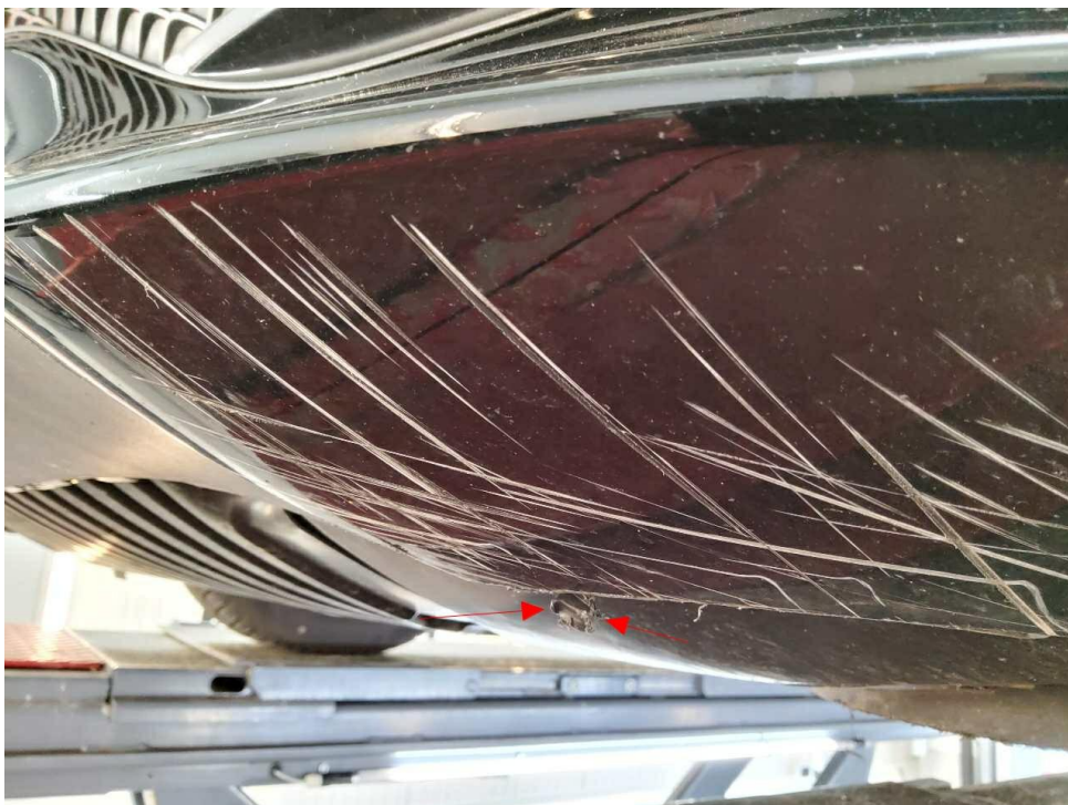
Bild 16 : Stoßfänger vorn verschrammt und Befestigungslaschen ausgerissen
