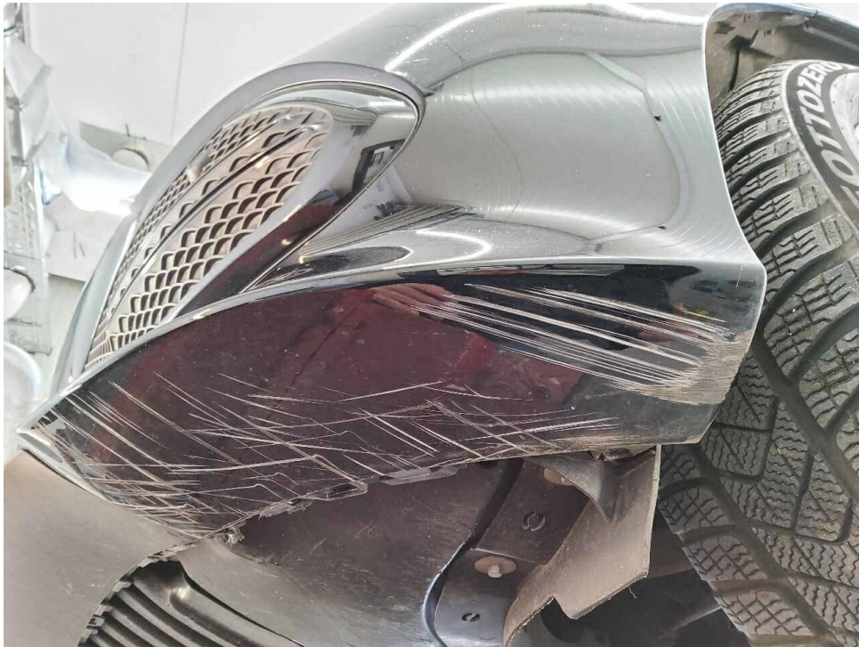
Bild 15 : Stoßfänger vorn verschrammt und Befestigungslaschen ausgerissen
