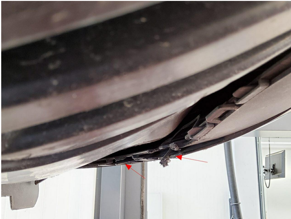
Bild 17 : Stoßfänger vorn verschrammt und Befestigungslaschen ausgerissen
