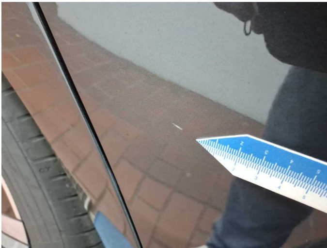
Damage 2: Door - rear right side: Door - Scratch(es) - Paint
