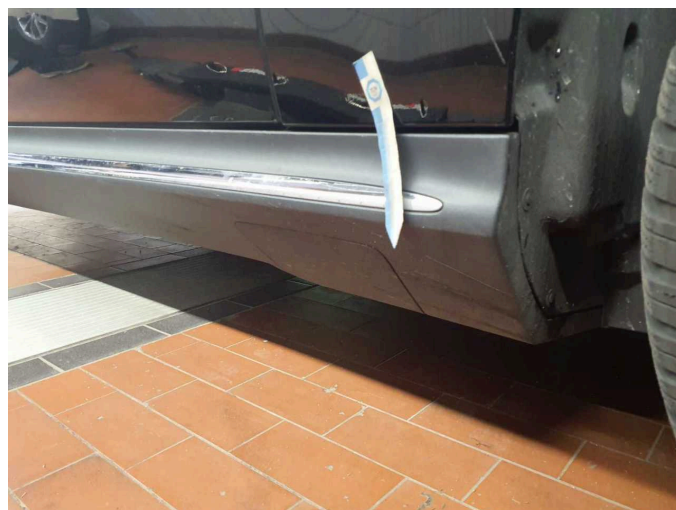
Beschädigung 8: Schweller rechts: Verkleidung - verkratzt / verschürft - erneuern
