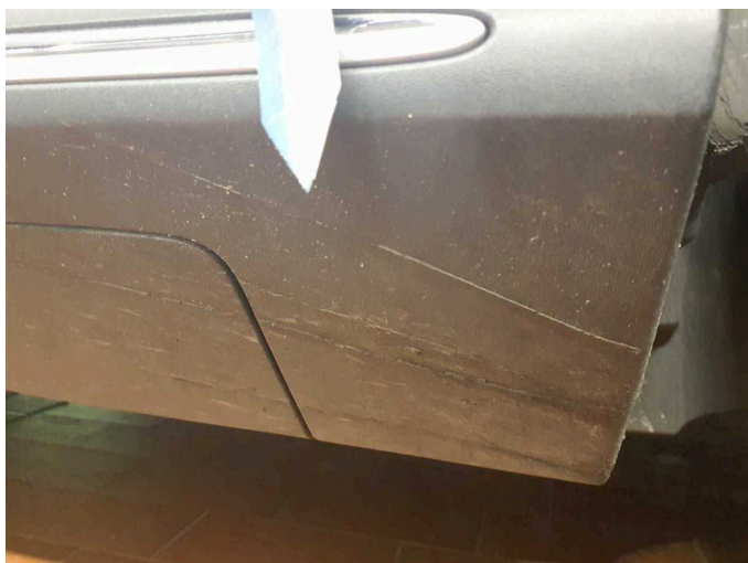
Beschädigung 8: Schweller rechts: Verkleidung - verkratzt / verschürft - erneuern
