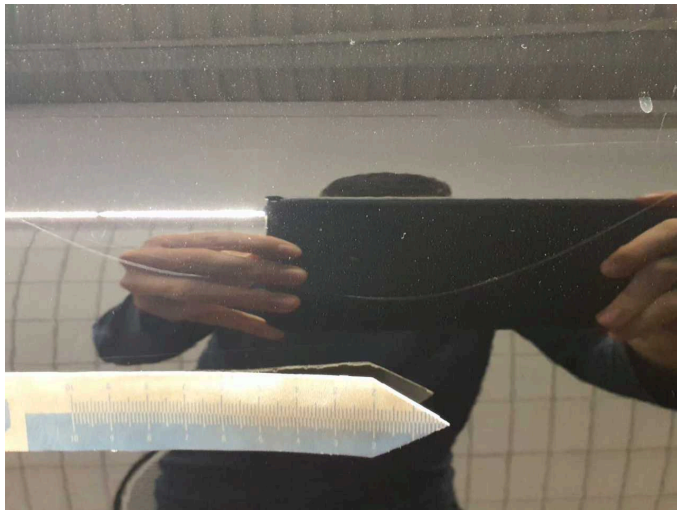
Beschädigung 5: Karosserie: Karosserie (Oberflächenkratzer) - verkratzt / verschürft - aufbereiten
