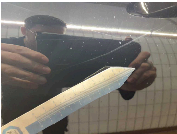
Beschädigung 5: Karosserie: Karosserie (Oberflächenkratzer) - verkratzt / verschürft - aufbereiten
