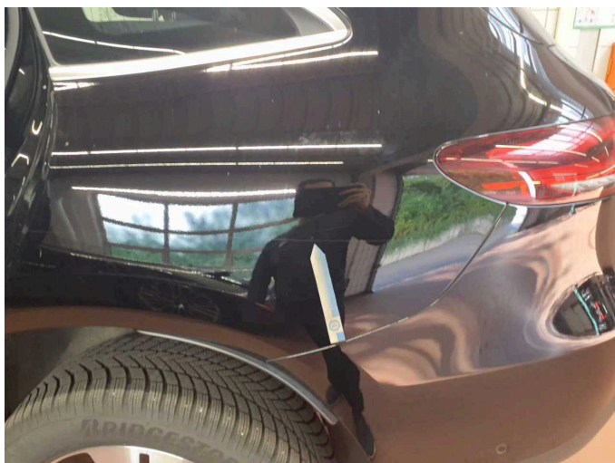
Beschädigung 12: Seitenwand links: Seitenwand - verkratzt / verschürft - lackieren
