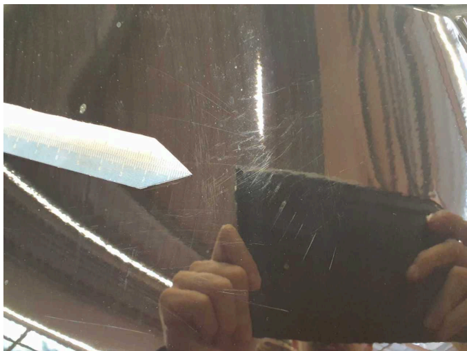
Beschädigung 12: Seitenwand links: Seitenwand - verkratzt / verschürft - lackieren
