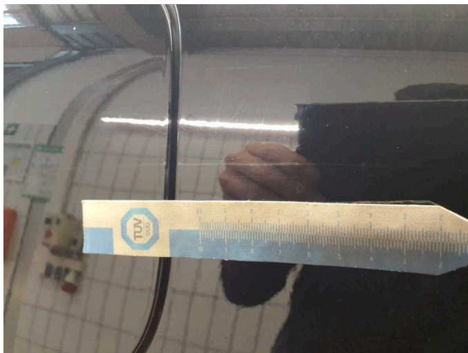
Beschädigung 5: Karosserie: Karosserie (Oberflächenkratzer) - verkratzt / verschürft - aufbereiten
