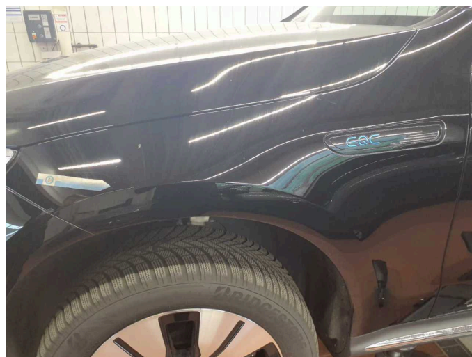
Beschädigung 5: Karosserie: Karosserie (Oberflächenkratzer) - verkratzt / verschürft - aufbereiten
