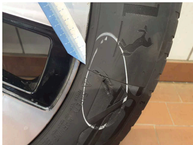
Beschädigung 4: 2.Radsatz: 1 Reifen - beschädigt - erneuern
