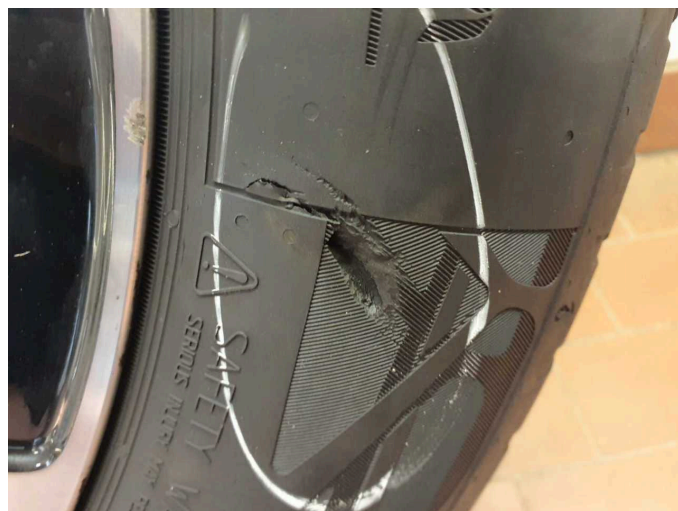
Beschädigung 4: 2.Radsatz: 1 Reifen - beschädigt - erneuern
