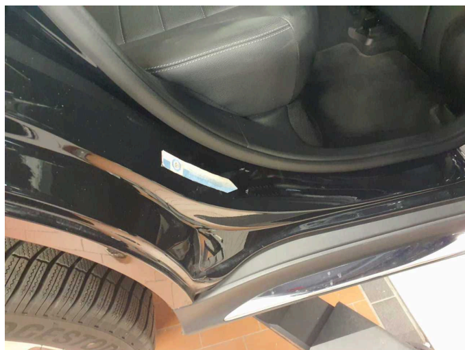
Beschädigung 6: Seitenwand rechts: Einstieg - Delle / Lackschaden - Smart Repair
