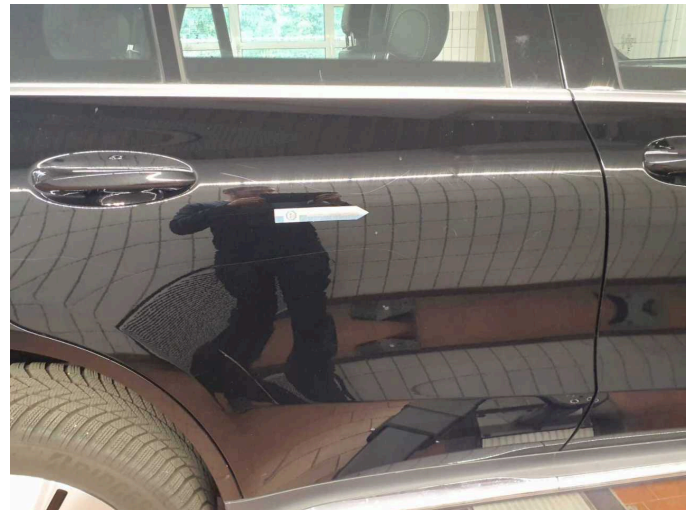
Beschädigung 5: Karosserie: Karosserie (Oberflächenkratzer) - verkratzt / verschürft - aufbereiten
