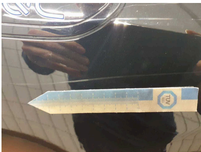
Beschädigung 5: Karosserie: Karosserie (Oberflächenkratzer) - verkratzt / verschürft - aufbereiten
