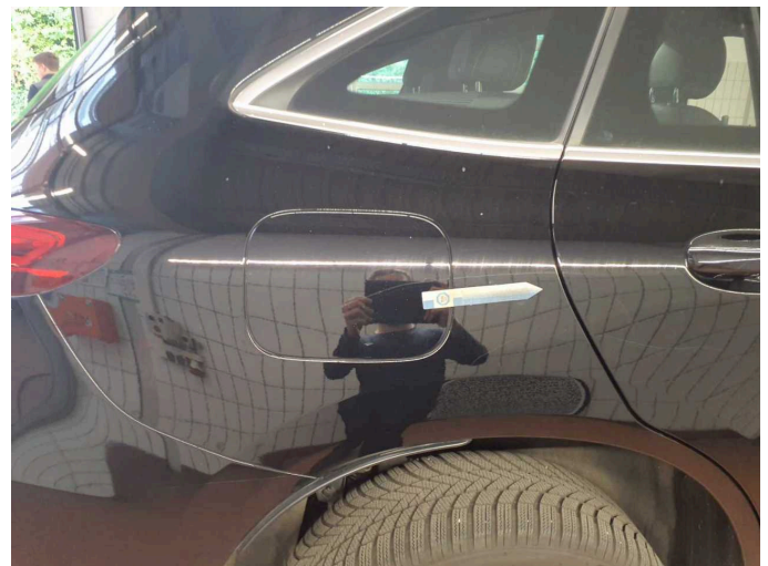
Beschädigung 5: Karosserie: Karosserie (Oberflächenkratzer) - verkratzt / verschürft - aufbereiten
