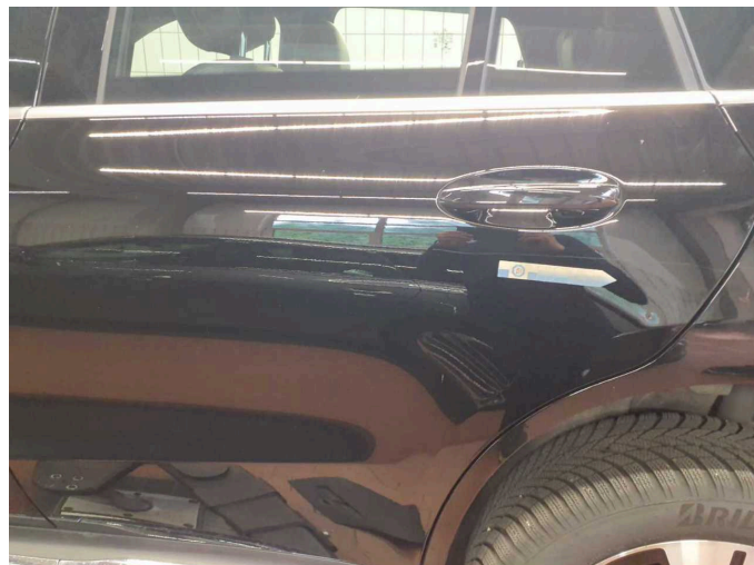
Beschädigung 5: Karosserie: Karosserie (Oberflächenkratzer) - verkratzt / verschürft - aufbereiten
