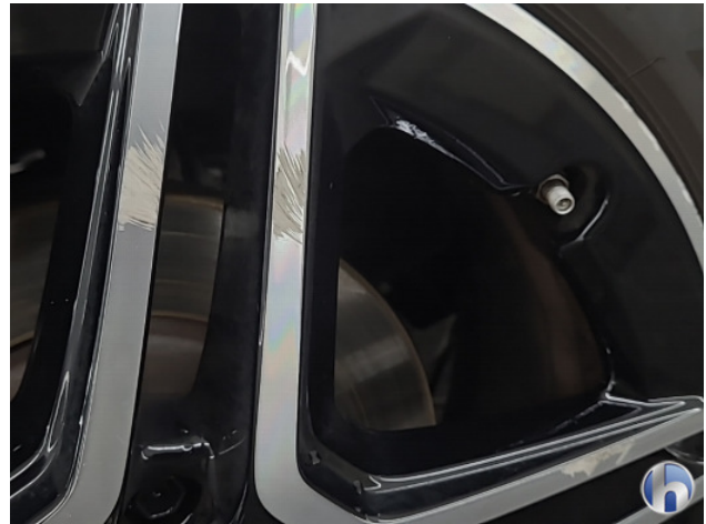
2. Velg achter- rechts Beschadigd - Herstellen
