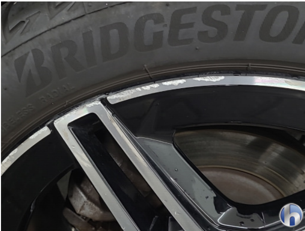
2. Velg achter- rechts Beschadigd - Herstellen
