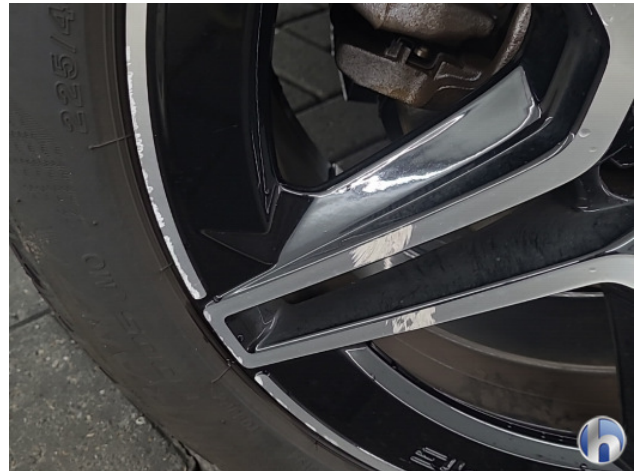
2. Velg achter- rechts Beschadigd - Herstellen
