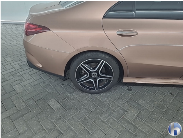
2. Velg achter- rechts Beschadigd - Herstellen
