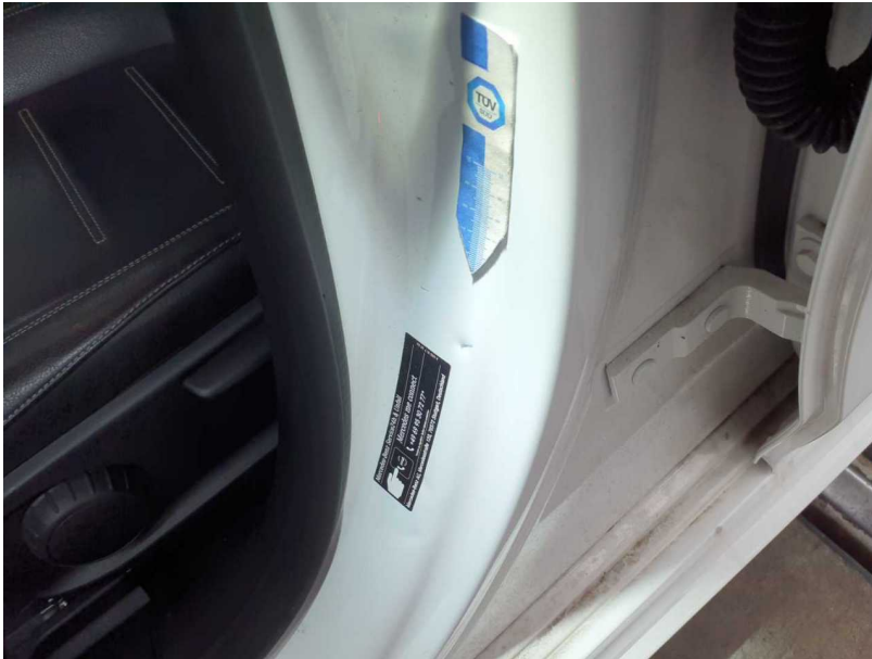
Beschädigung #1: Schweller links: Einstieg - Delle / Lackschaden - instandsetzen und lackieren
