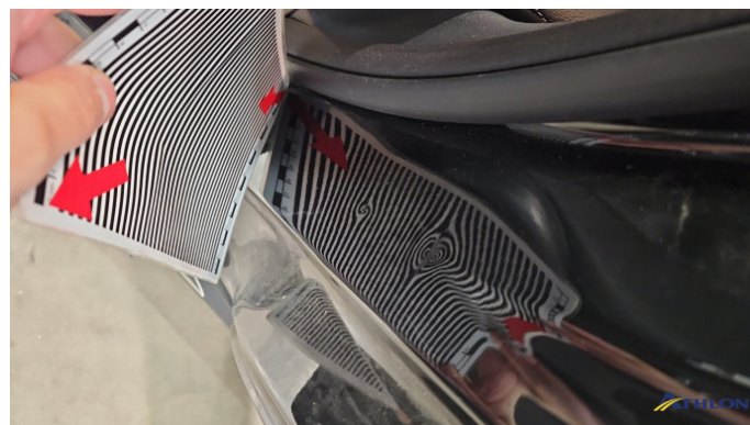
2. Türeinstieg Hinten - Links Verformt (leicht)
