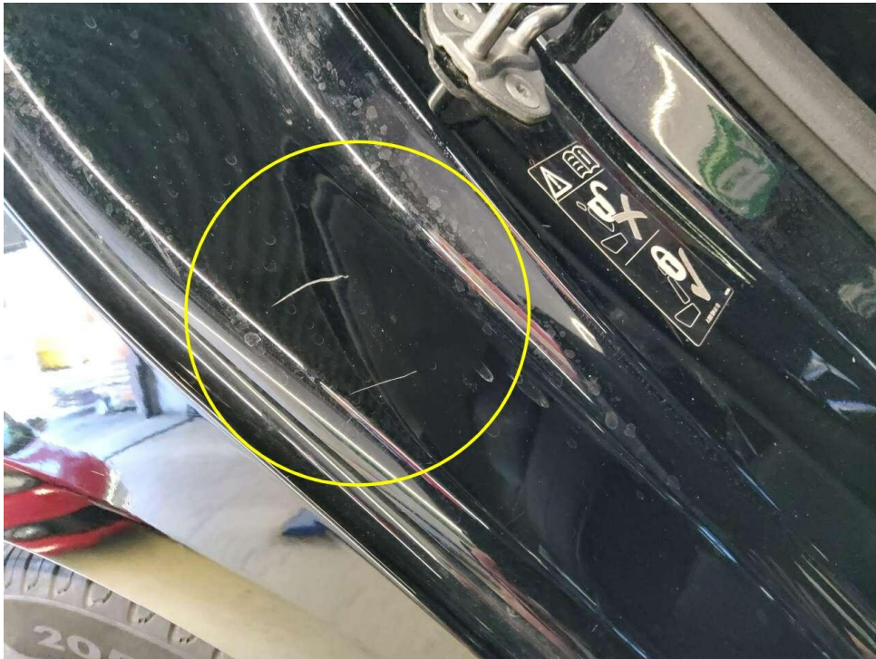
Bild 21 : Einstieg hinten rechts verschrammt
