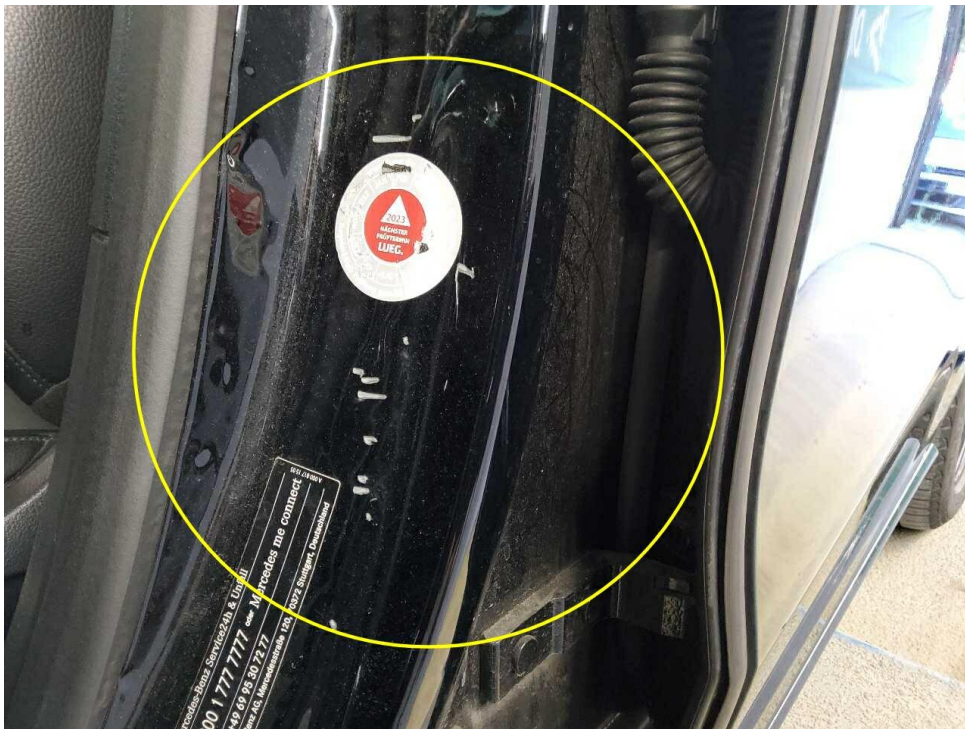
Bild 24 : Einstieg vorne links verschrammt
