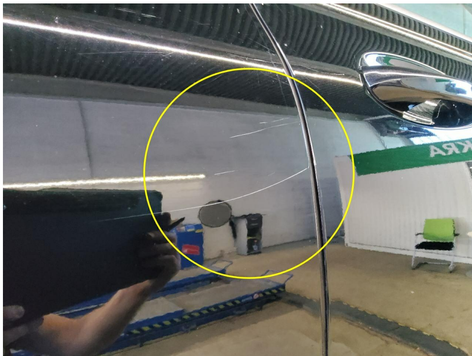
Bild 19 : Türe hinten rechts lackierung verschrammt und eingedellt
