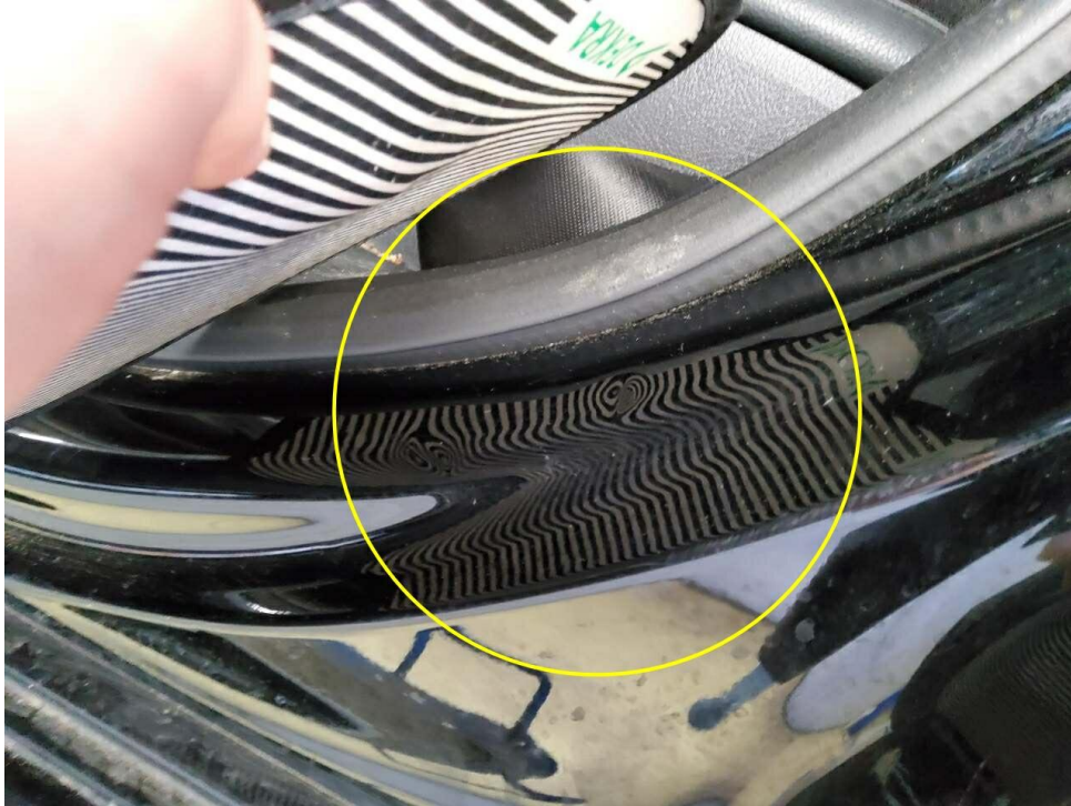
Bild 23 : Einstieg hinten links deformiert
