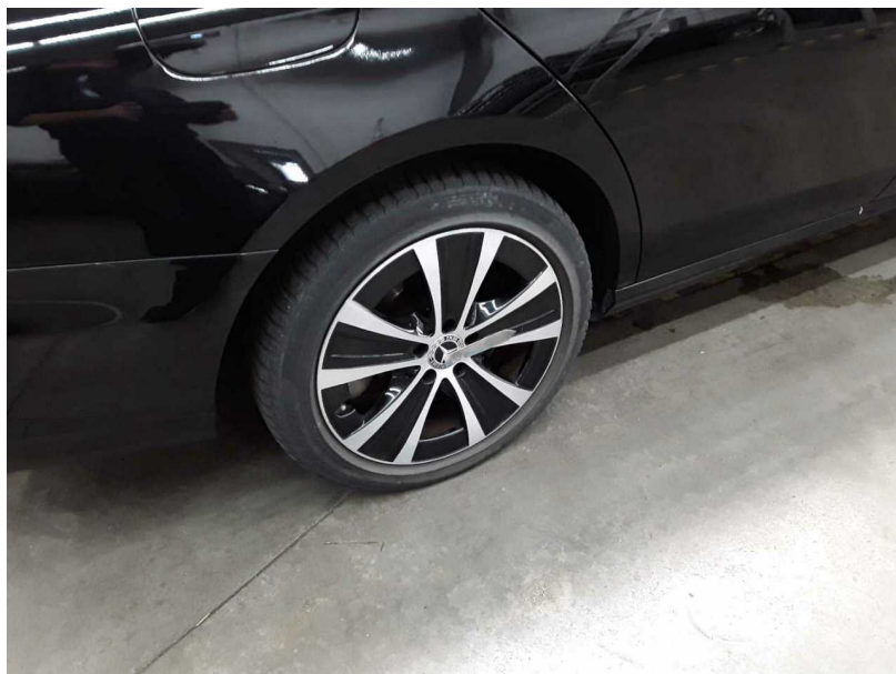
Beschädigung #6: Rad/Reifen: Leichtmetallfelge hinten rechts - Kratzer - Wertminderung
