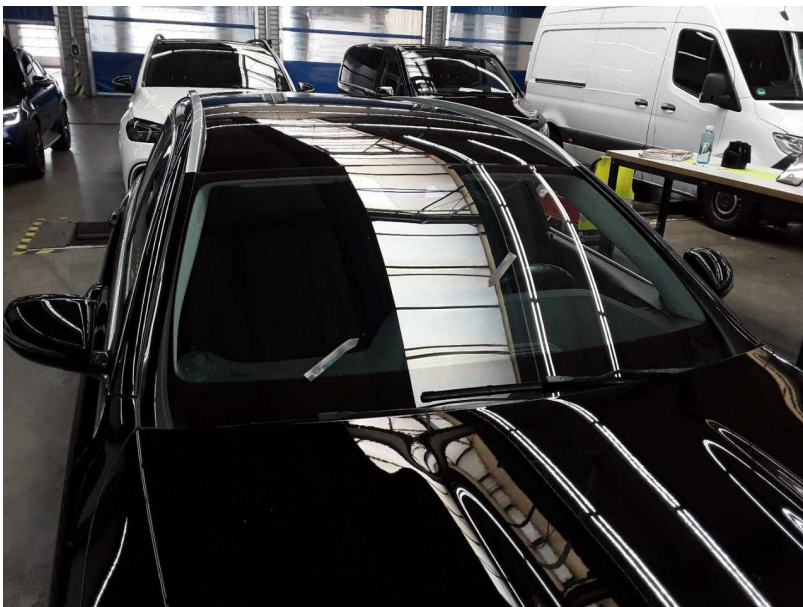
Beschädigung #10: Verglasung: Frontscheibe mit Spurhalteassistent - Steinschlag - erneuern
