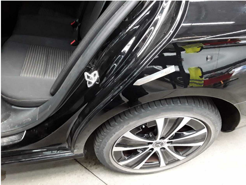
Beschädigung #3: Seitenwand links: Seitenwand - Kratzer - Smart Repair
