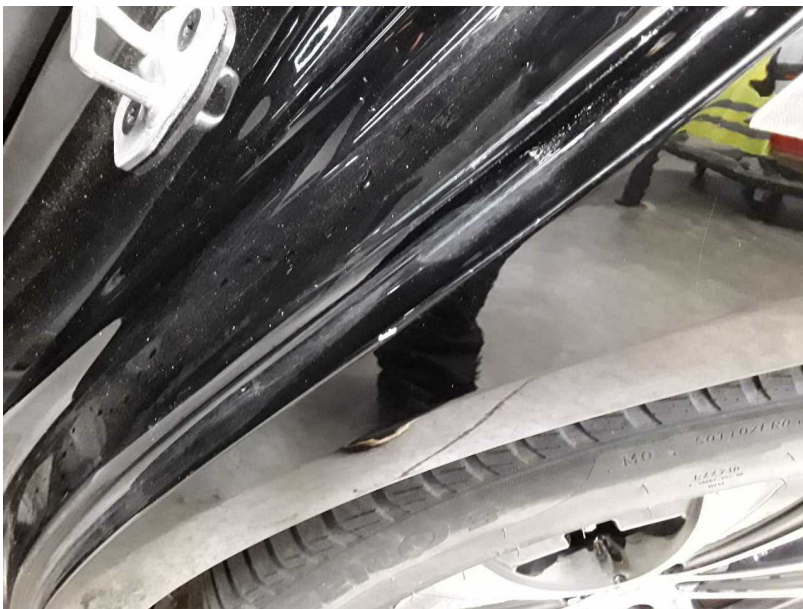
Beschädigung #3: Seitenwand links: Seitenwand - Kratzer - Smart Repair
