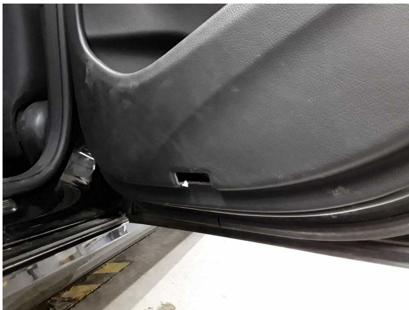
Beschädigung #1: Zusatzleuchte: Einstiegsleuchte rechts (hinten) - fehlt - erneuern
