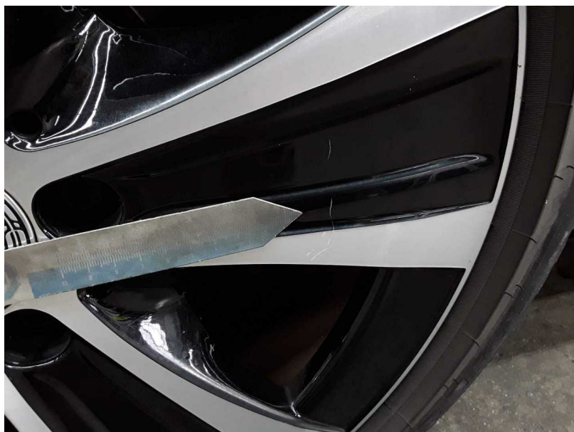
Beschädigung #6: Rad/Reifen: Leichtmetallfelge hinten rechts - Kratzer - Wertminderung
