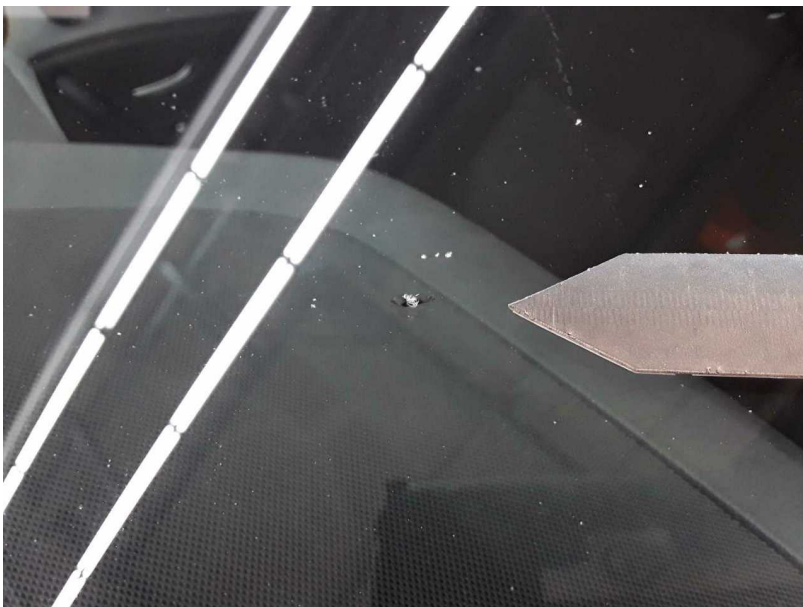
Beschädigung #10: Verglasung: Frontscheibe mit Spurhalteassistent - Steinschlag - erneuern
