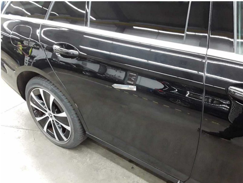
Beschädigung #4: Tür hinten rechts: Tür - Delle(n) - Smart Repair
