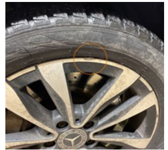
6.7.18 - Vinterfälg höger fram Kantstött
