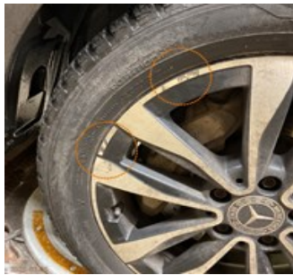
6.7.18 - Vinterfälg höger fram Kantstött
