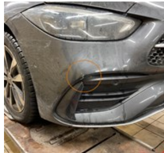
7.4.1 - Stötfångare fram Skrapad vänster sida. Buckla med repor höger sida. Skrapad underkant
