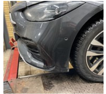
7.4.1 - Stötfångare fram Skrapad vänster sida. Buckla med repor höger sida. Skrapad underkant
