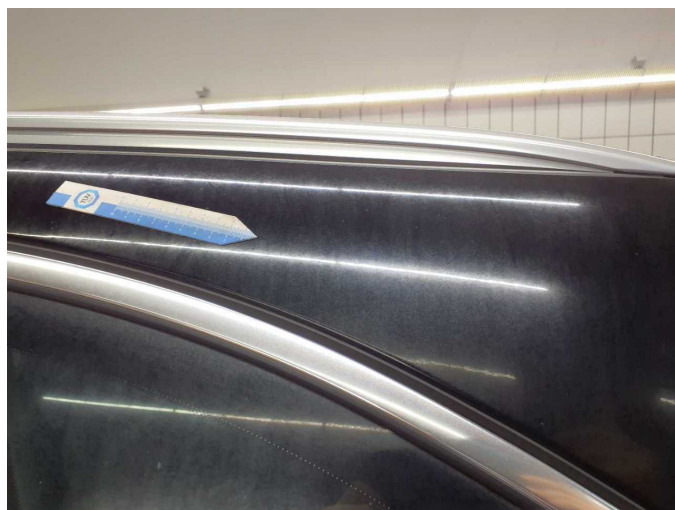
Damage 8: Body: Body (Ausgeblichen folgekosten möglich) - Paint defect - Conditioning
