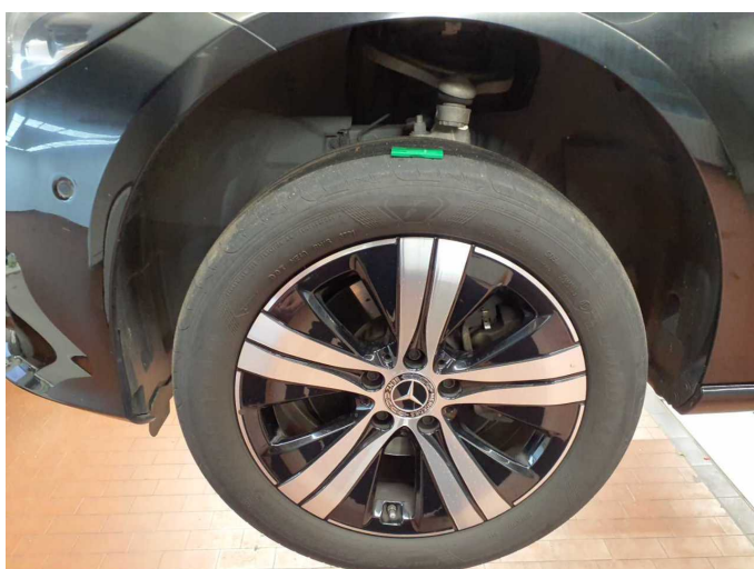
Damage 9: Wheel / tyres: Tyre - front (Einseitig abgefahren) - Worn - Replace
