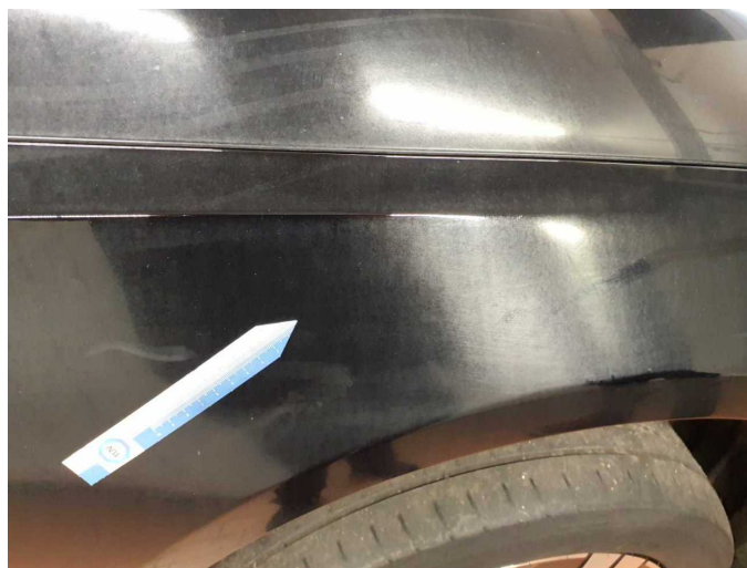
Damage 8: Body: Body (Ausgeblichen folgekosten möglich) - Paint defect - Conditioning
