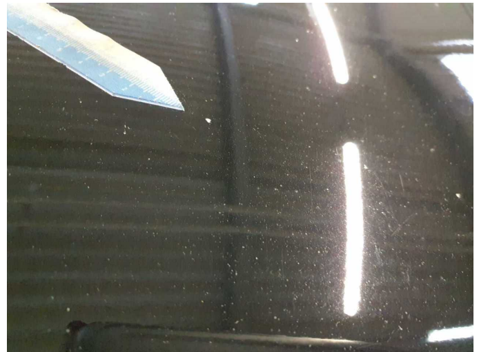
Damage 10: Bonnet: Bonnet (Sandstrahleffekt) - Stone chips - Paint
