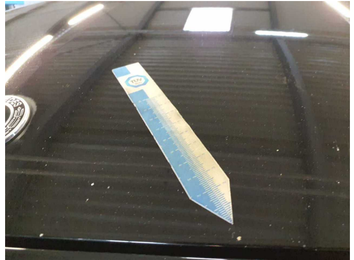
Damage 10: Bonnet: Bonnet (Sandstrahleffekt) - Stone chips - Paint
