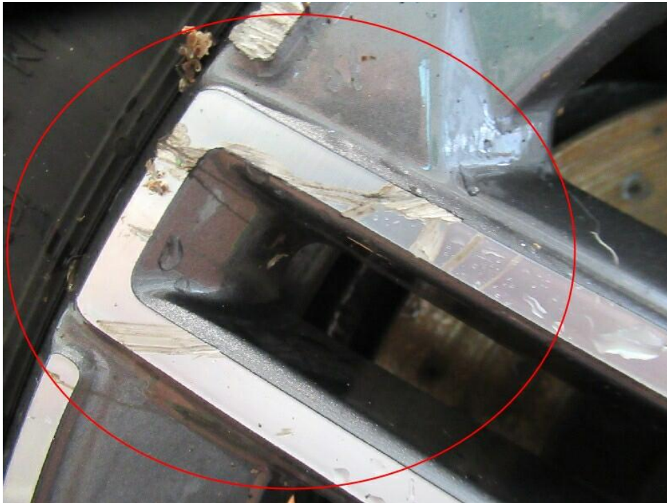
Bild 19 : Felge vorn links, verschrammt Glanzgedreht
