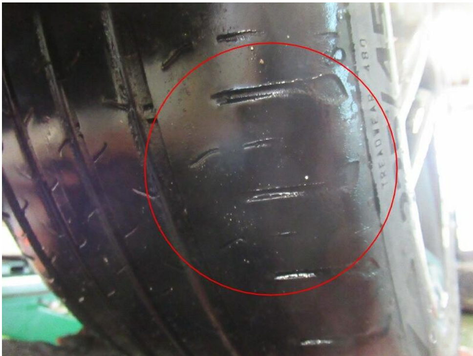
Bild 28 : Sommerreifen vorn, verschlissen links
