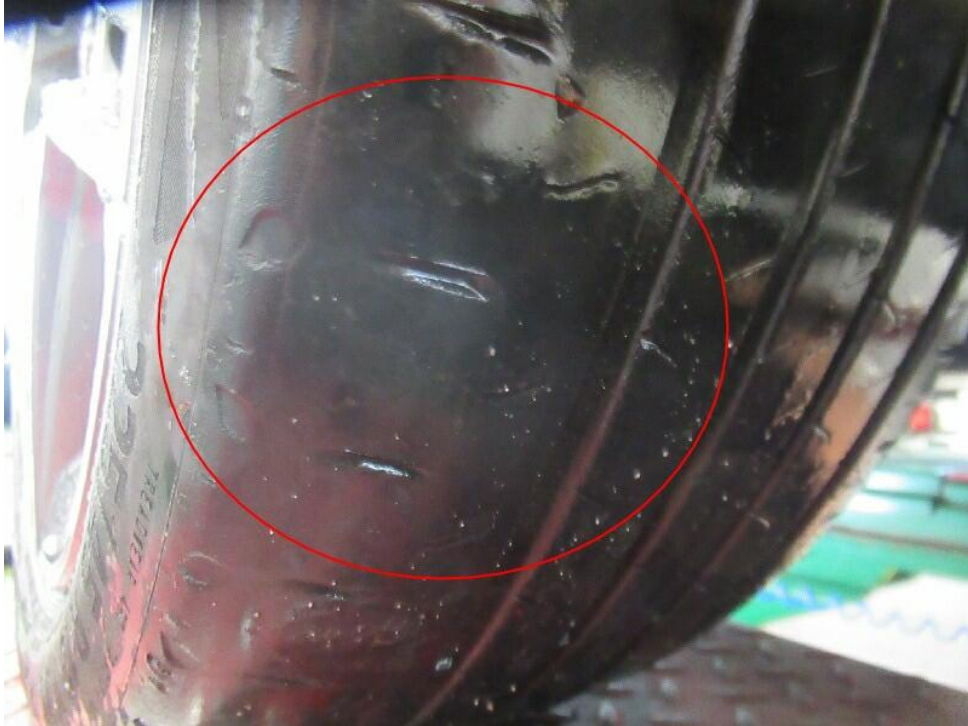
Bild 29 : Sommerreifen vorn, verschlissen rechts
