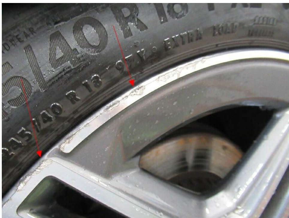
Bild 24 : Felge hinten rechts, verschrammt Glanzgedreht
