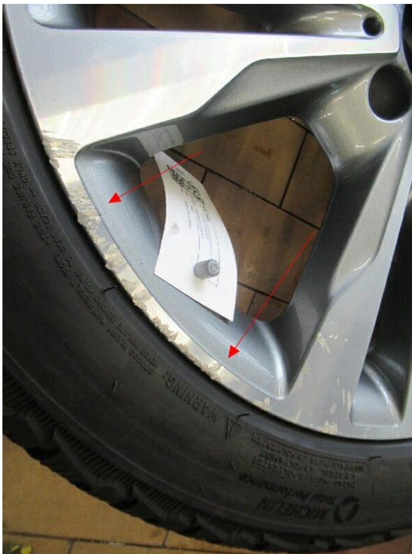
Bild 30 : Winterradfelge vorn rechts, verschrammt, Glanzgedreht
