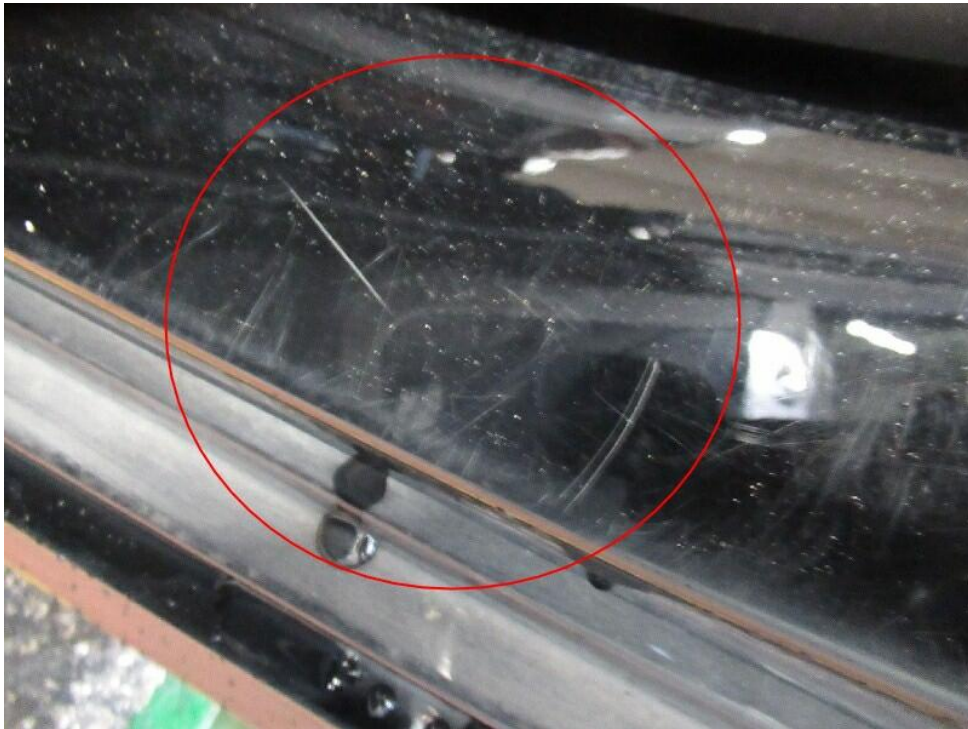
Bild 27 : Tür hinten links Einstieg, zerkratzt, smart repair
