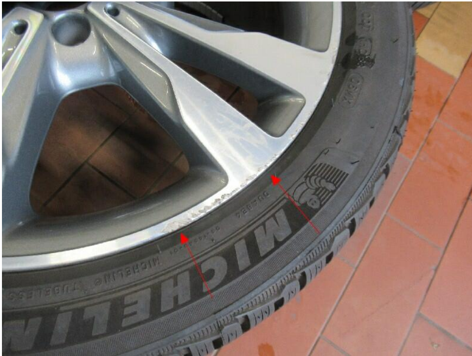
Bild 31 : Winterradfelge hinten rechts, verschrammt, Glanzgedreht
