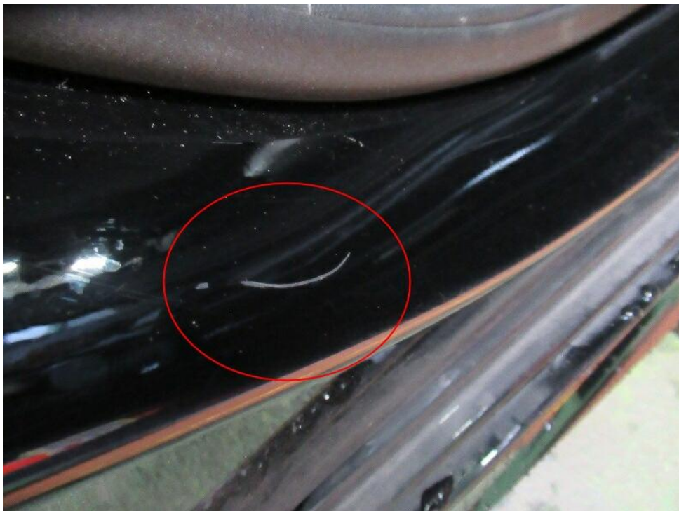
Bild 22 : Tür hinten rechts Einstieg, zerkratzt, smart repair
