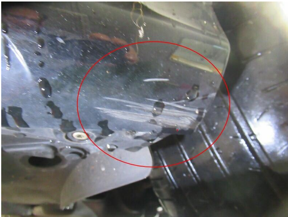
Bild 20 : Stoßfänger vorne, verschrammt, smart repair
