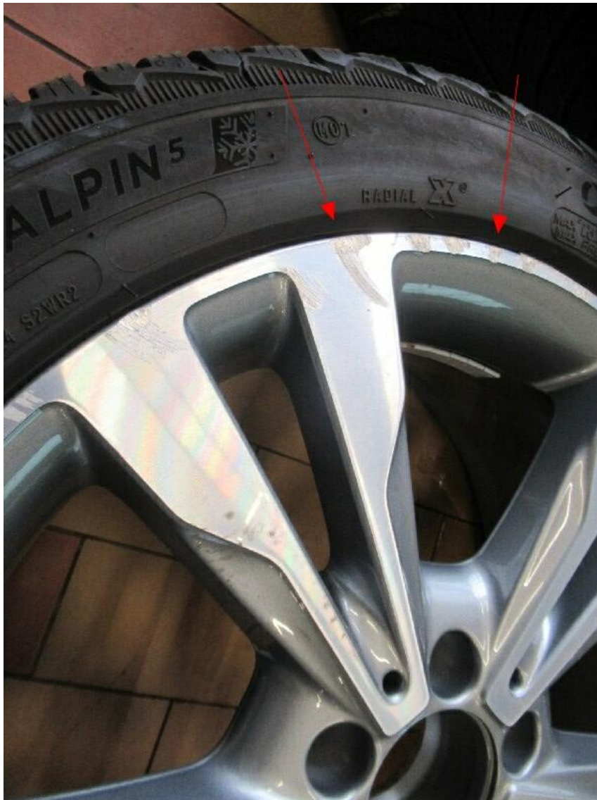
Bild 32 : Winterradfelge hinten rechts, verschrammt, Wertminderung
