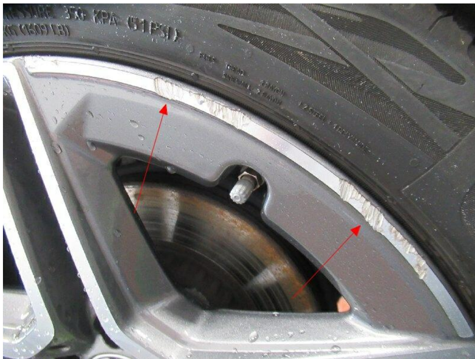
Bild 23 : Felge hinten rechts, verschrammt Glanzgedreht
