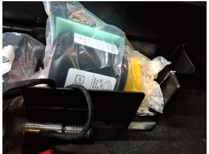
Damage 1: Equipment: Tirefit filler (Ausgelaufen) - Damaged - Replace
