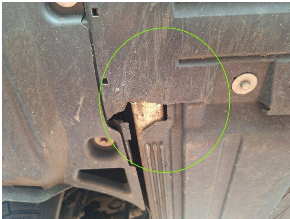
Bild 18 : Verkleidung Unterboden vorne gebrochen
