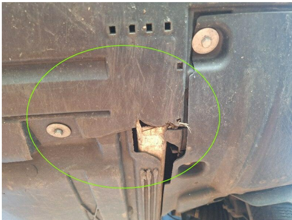
Bild 17 : Verkleidung Unterboden vorne gebrochen
