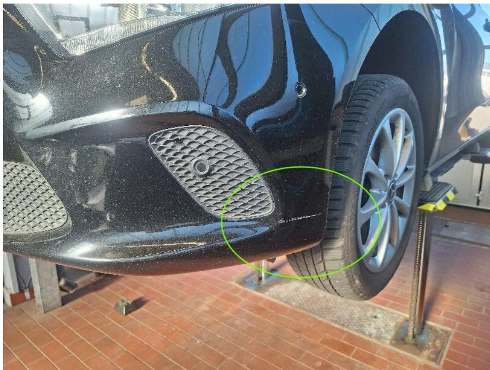
Bild 15 : Stoßfänger vorne zerkratzt
