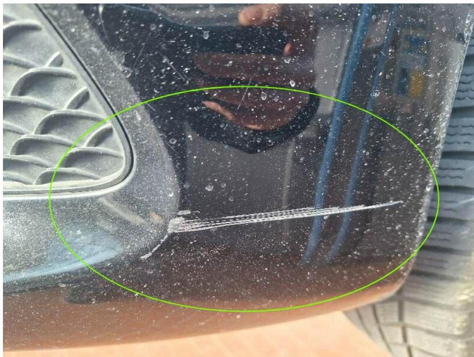
Bild 16 : Stoßfänger vorne zerkratzt
