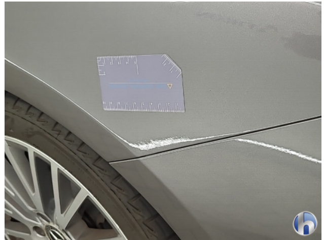
2. Oneffenheden lak Gebruikssporen - Aanvaardbaar
