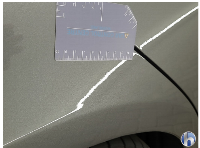
2. Oneffenheden lak Gebruikssporen - Aanvaardbaar
