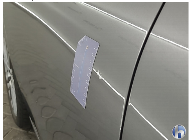
2. Oneffenheden lak Gebruikssporen - Aanvaardbaar
