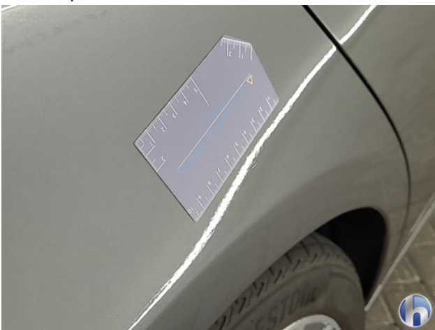
2. Oneffenheden lak Gebruikssporen - Aanvaardbaar
