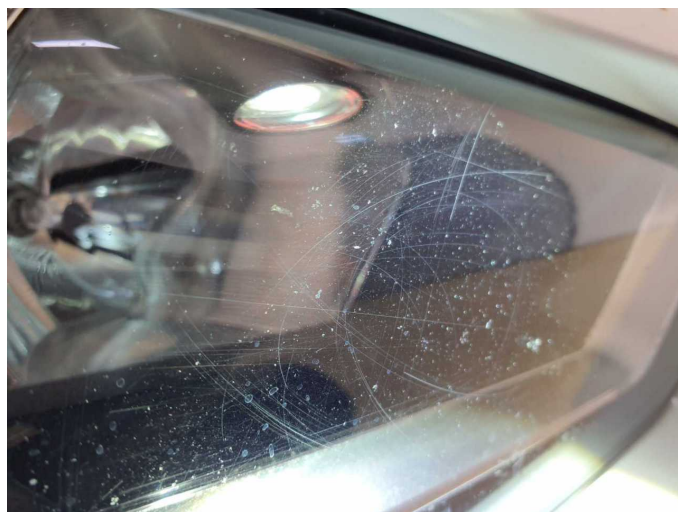
Beschädigung 3: Scheinwerfer: Scheinwerfer rechts - Kratzer - Wertminderung
