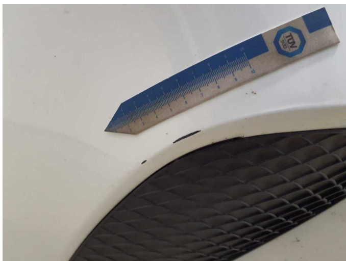
Beschädigung 5: Stossfänger vorn: Stossfänger vorn - Delle / Lackschaden - instandsetzen und lackieren
