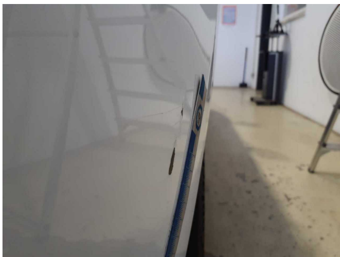
Beschädigung 6: Stossfänger hinten: Stossfänger hinten (Verformt) - verkratzt / verschürft - instandsetzen und lackieren
