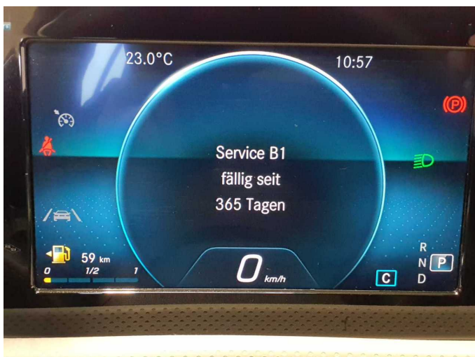
Beschädigung 4: Sonstiges: Inspektion/Wartung - fällig - erneuern
