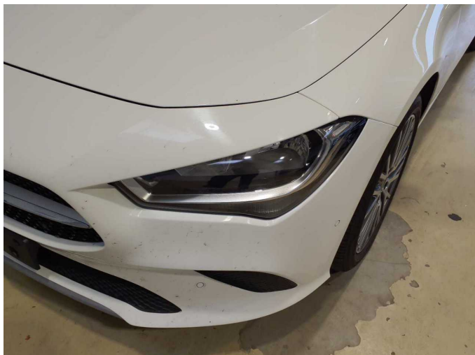
Beschädigung 2: Scheinwerfer: Scheinwerfer links - Kratzer - Wertminderung
