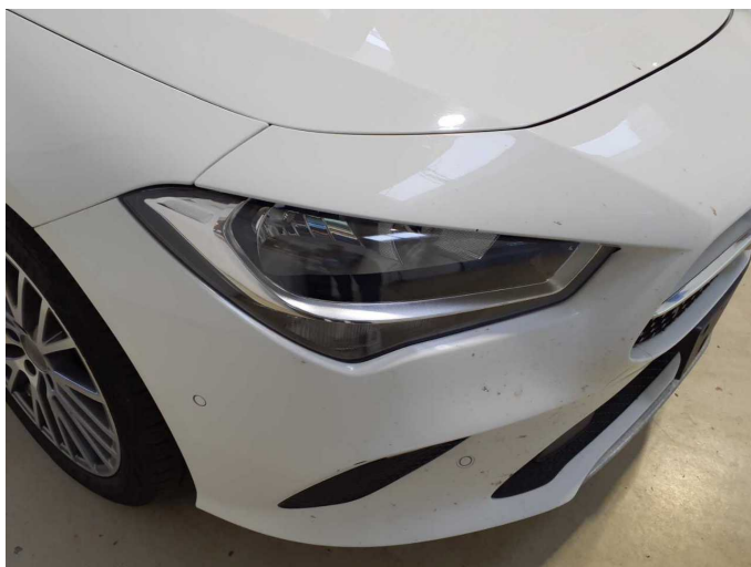
Beschädigung 3: Scheinwerfer: Scheinwerfer rechts - Kratzer - Wertminderung
