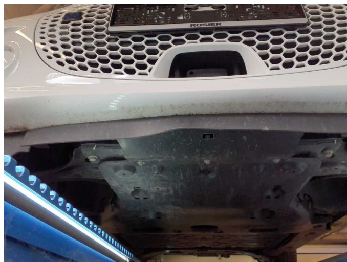
Beschädigung 6: Stossfänger vorn: Spoiler - verformt - erneuern
