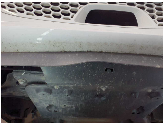
Beschädigung 6: Stossfänger vorn: Spoiler - verformt - erneuern
