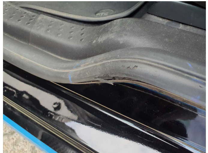
Beschädigung 4: Karosserie: Türdichtung vorn links - gebrochen / gerissen - erneuern
