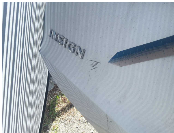
Beschädigung 4: Heckklappe/-tür: Heckklappe - Delle / Lackschaden - instandsetzen und lackieren
