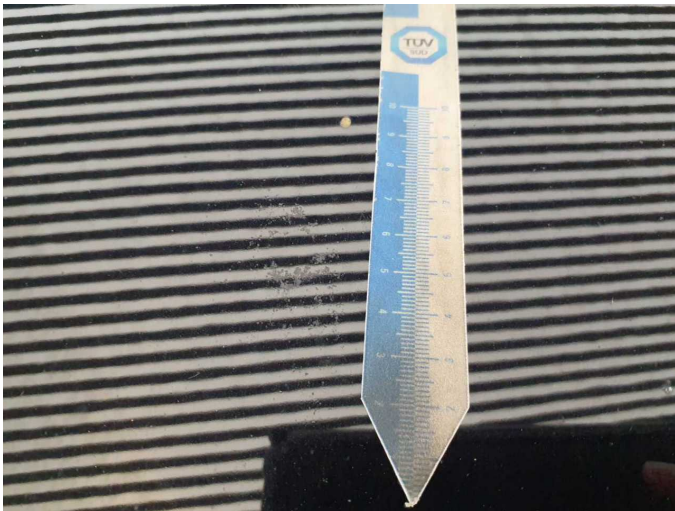
Damage 10: Bonnet: Bonnet (Anätzung) - Paint defect - Paint
