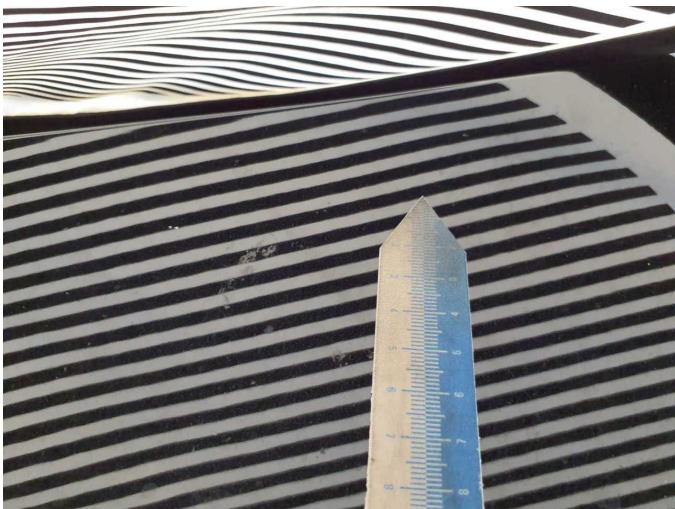
Damage 10: Bonnet: Bonnet (Anätzung) - Paint defect - Paint
