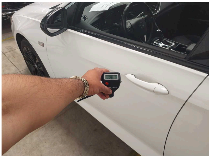
Door - front left side: 260 \mu\text{m}
