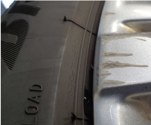
Damage 8: Wheel / tyres: Tyres - complete set (3 Reifen, nicht fahrbereit) - Porous / cracked - Replace
