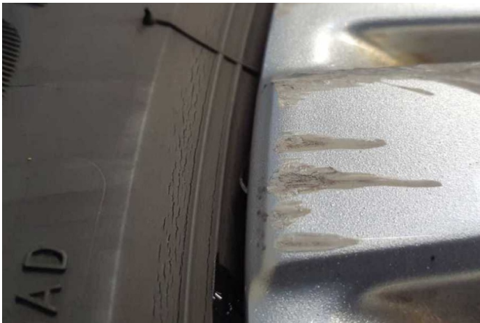
Damage 8: Wheel / tyres: Tyres - complete set (3 Reifen, nicht fahrbereit) - Porous / cracked - Replace
