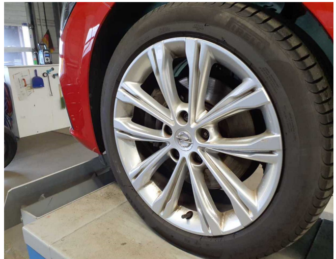
Damage 8: Wheel / tyres: Tyres - complete set (3 Reifen, nicht fahrbereit) - Porous / cracked - Replace
