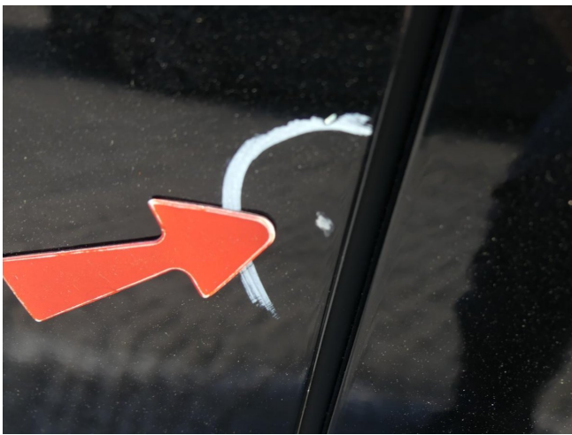
Tür VL - Lackabplatzer - Smartrepair
