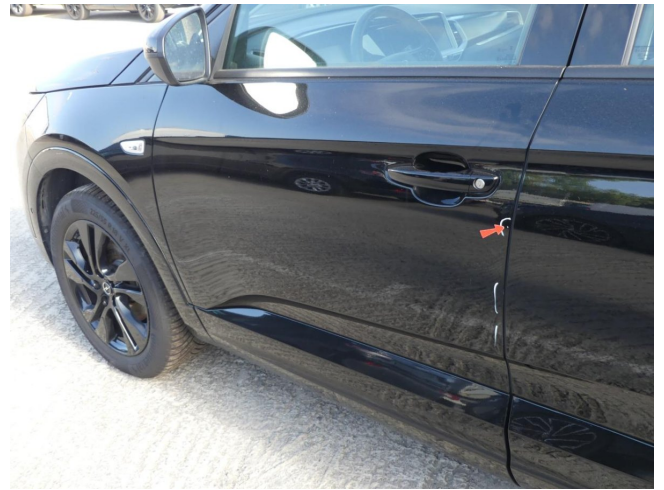
Tür VL - Lackabplatzer - Smartrepair
