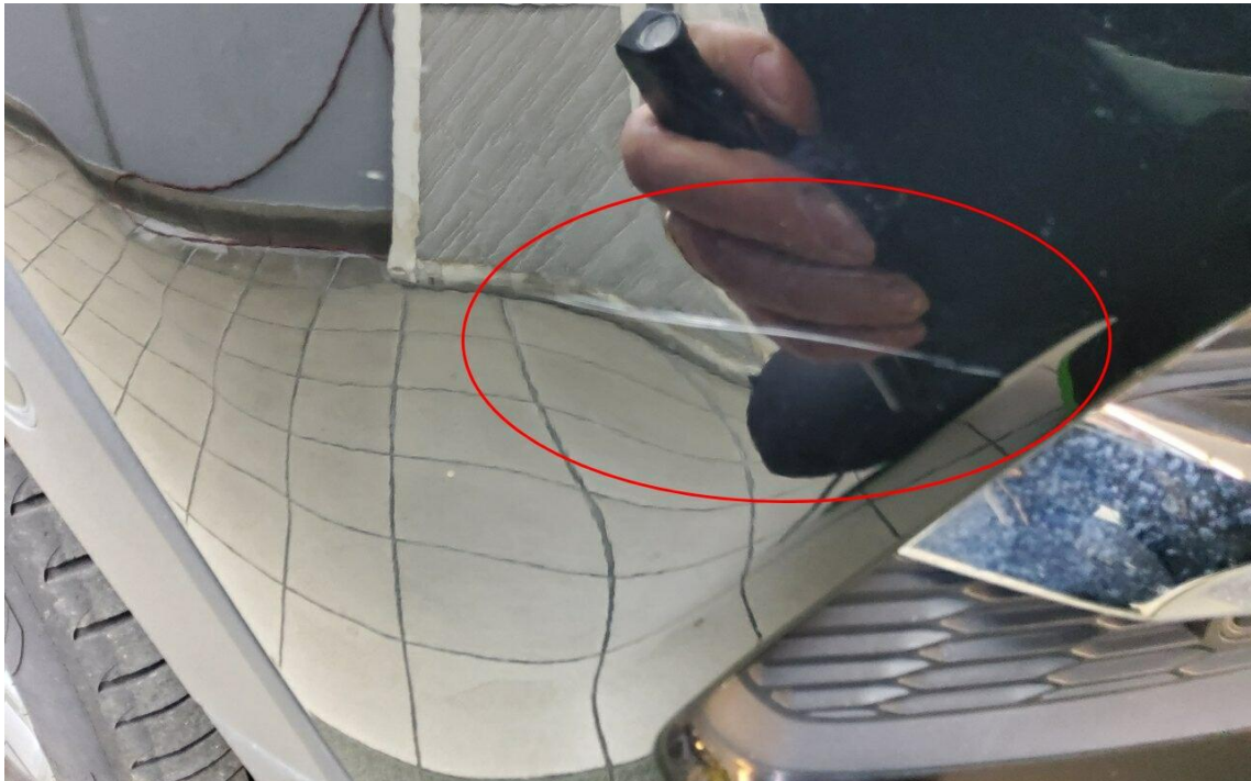
Bild 31 : Stoßfänger vorne Lackierung, zerkratzt, lackieren mit Lackaufbau
