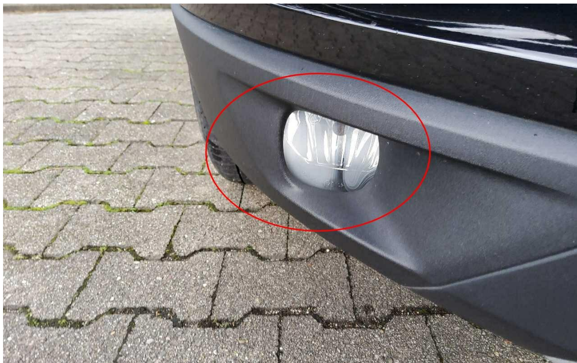
Bild 33 : T-Nebellampen vorne links und rechts eingelaufen,
