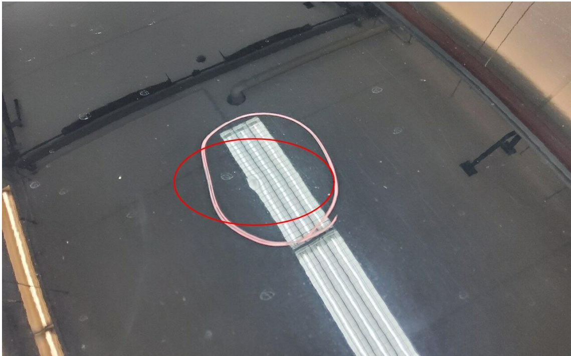
Bild 27 : Motorhaube Lackierung, viele Steinschläge, lackieren mit Lackaufbau, Delle
