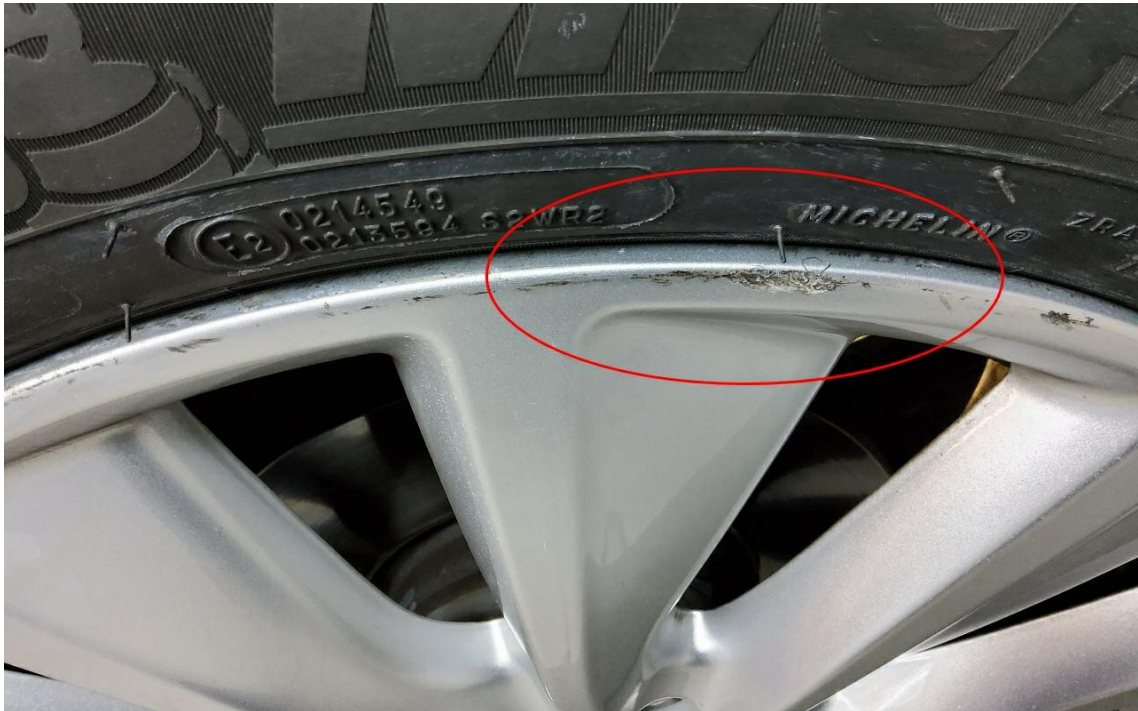
Bild 41 : Felge vorne links Lackierung, verschrammt, lackieren mit Lackaufbau
