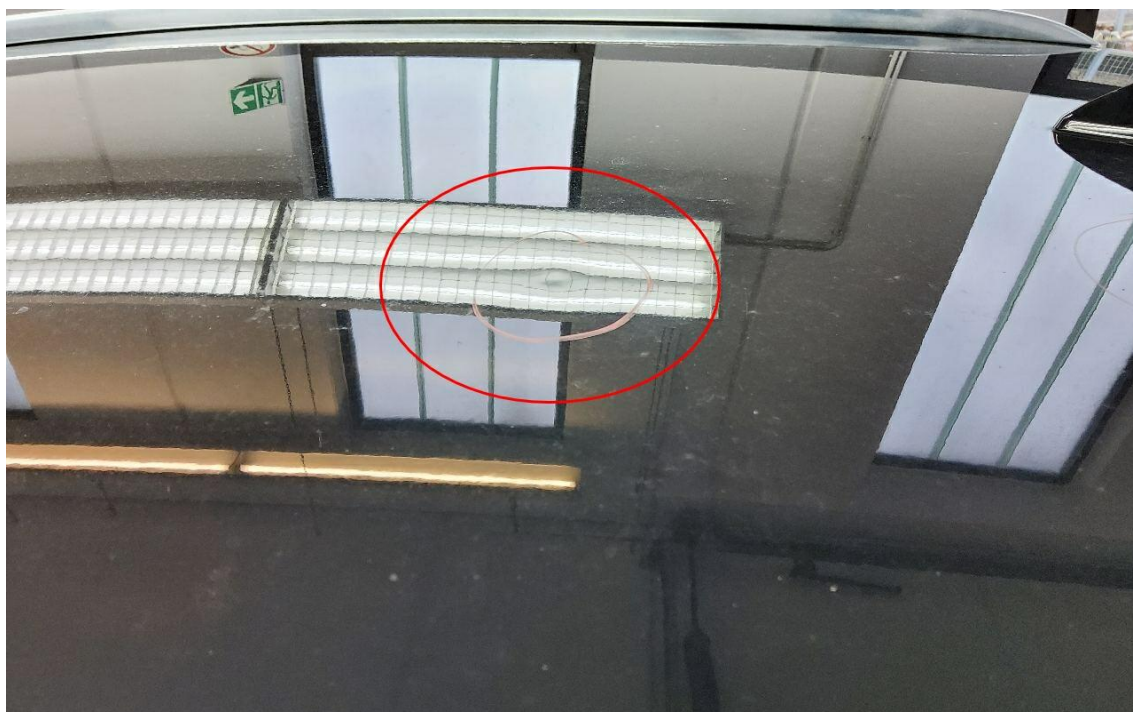
Bild 22 : Dach, eingedellt, drücken
