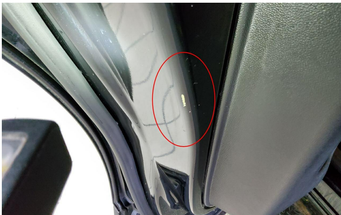
Bild 40 : Tür hinten links Türrahmen, zerkratzt, smart repair
