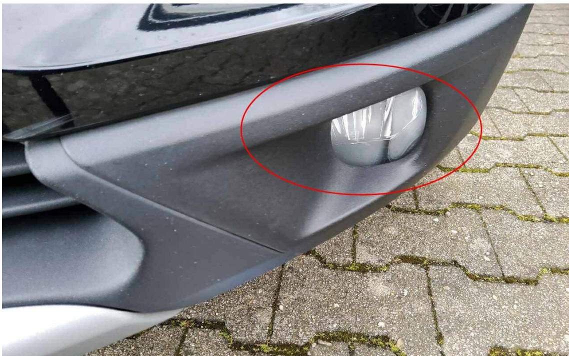
Bild 32 : T-Nebellampen vorne links und rechts eingelaufen,
