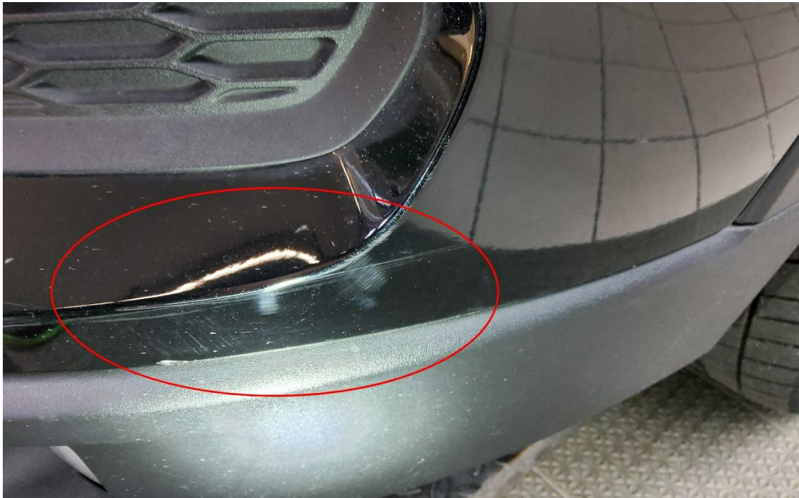
Bild 29 : Stoßfänger vorne Lackierung, zerkratzt, lackieren mit Lackaufbau
