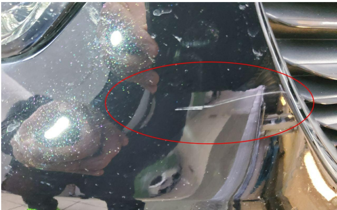
Bild 30 : Stoßfänger vorne Lackierung, zerkratzt, lackieren mit Lackaufbau
