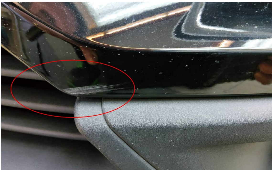
Bild 28 : Stoßfänger vorne Lackierung, zerkratzt, lackieren mit Lackaufbau
