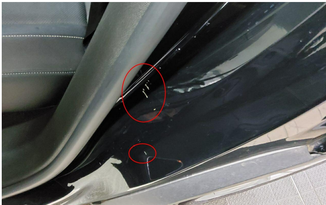
Bild 39 : Tür hinten links Einstieg, zerkratzt, smart repair
