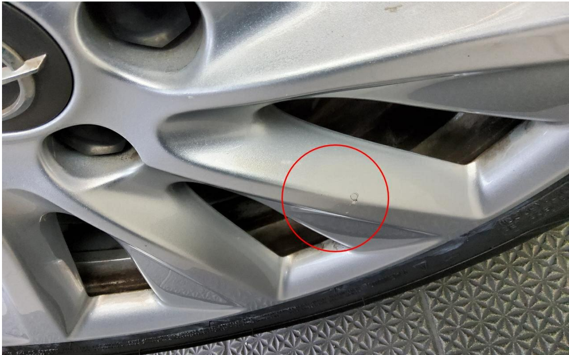
Bild 43 : Felge hinten rechts Lackierung, zerkratzt, Gebrauchsspur
