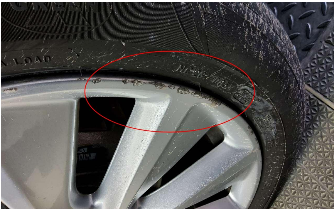
Bild 42 : Felge hinten links Lackierung, verschrammt, lackieren mit Lackaufbau
