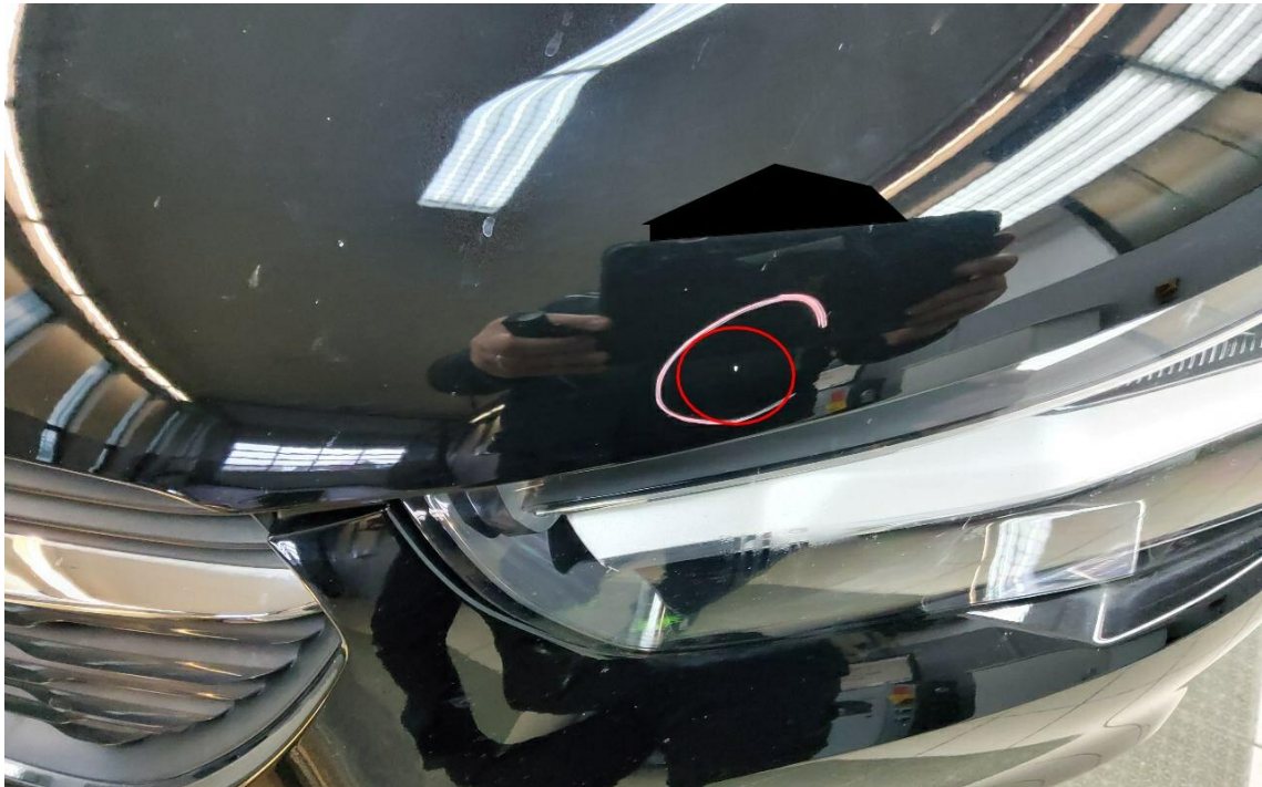
Bild 25 : Motorhaube Lackierung, viele Steinschläge, lackieren mit Lackaufbau
