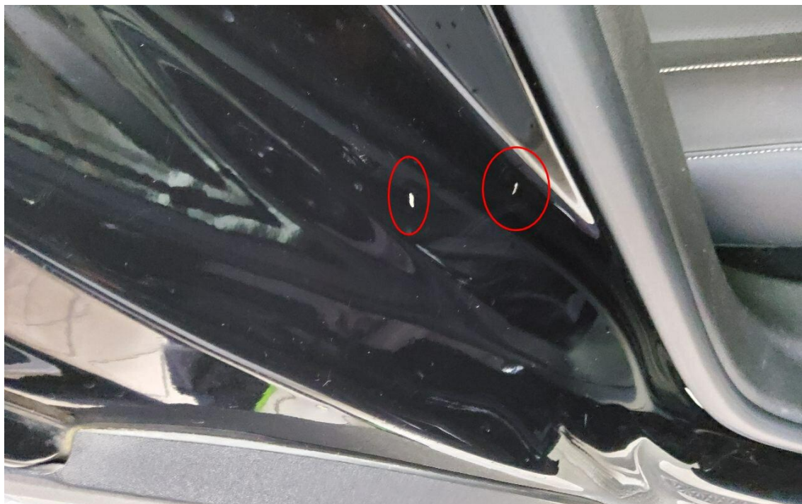
Bild 35 : Tür hinten rechts Einstieg, zerkratzt, smart repair
