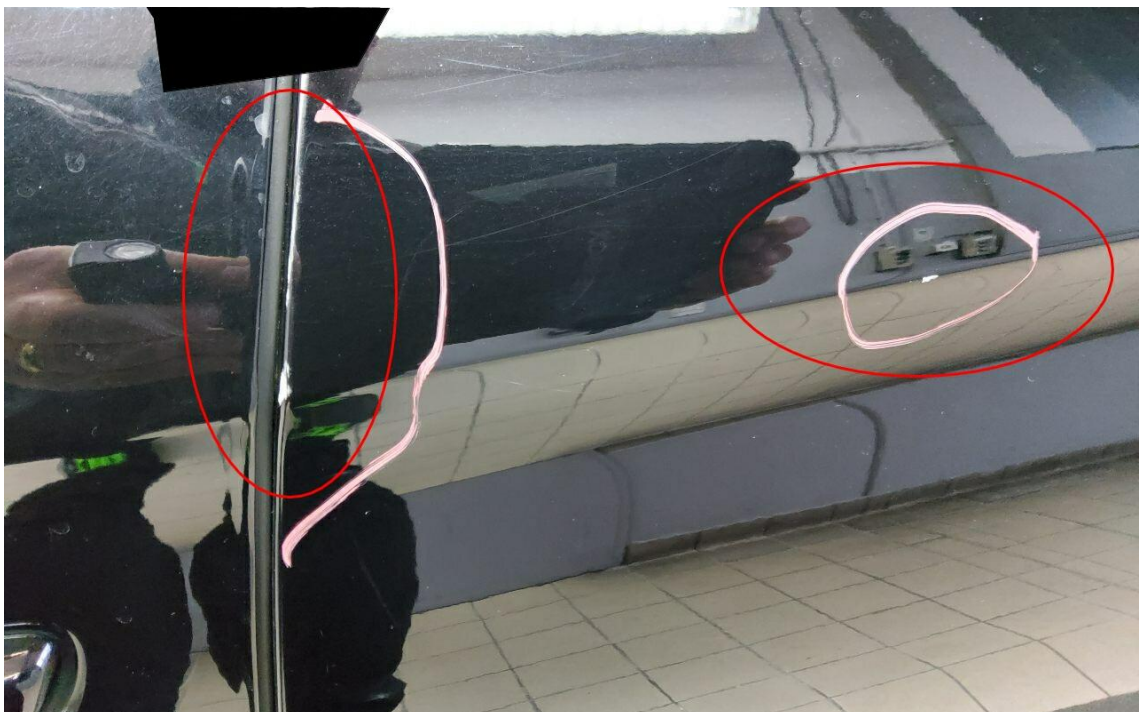
Bild 38 : Tür hinten links Lackierung, zerkratzt, lackieren mit Lackaufbau
