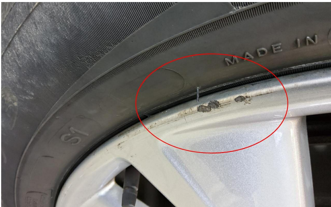
Bild 44 : Felge vorne rechts Lackierung, verschrammt, lackieren mit Lackaufbau
