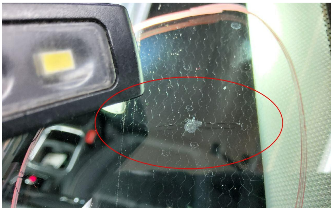
Bild 24 : T-Frontscheibe Steinschlag mit Rissbildung
