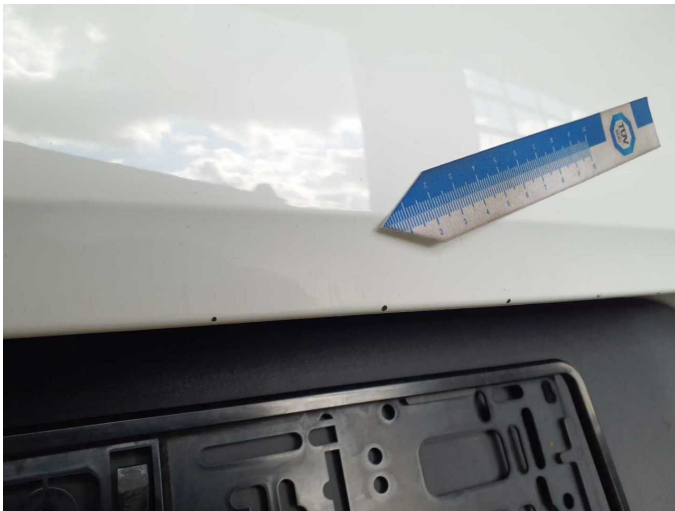
Damage 2: Boot lid / rear door: Boot lid (Kante) - Scratched - Smart repair
