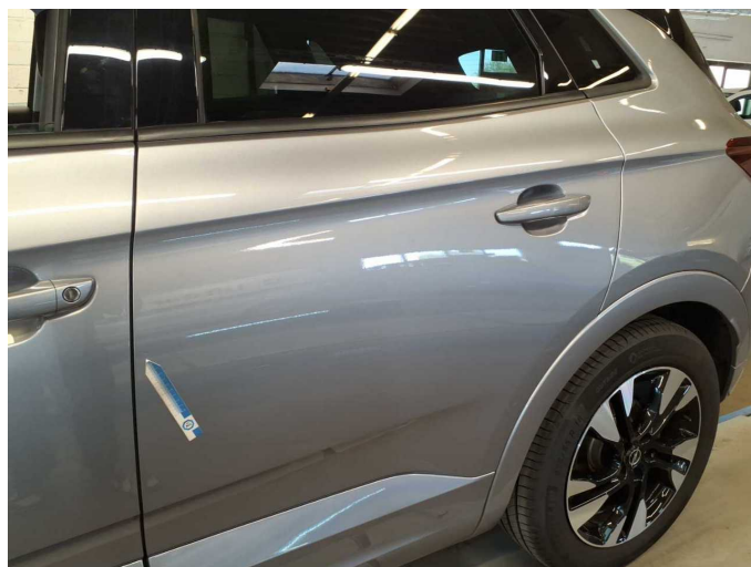
Beschädigung 3: Tür hinten links: Tür - Kratzer - lackieren
