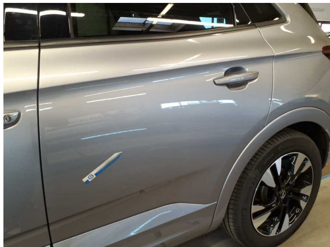
Beschädigung 3: Tür hinten links: Tür - Kratzer - lackieren
