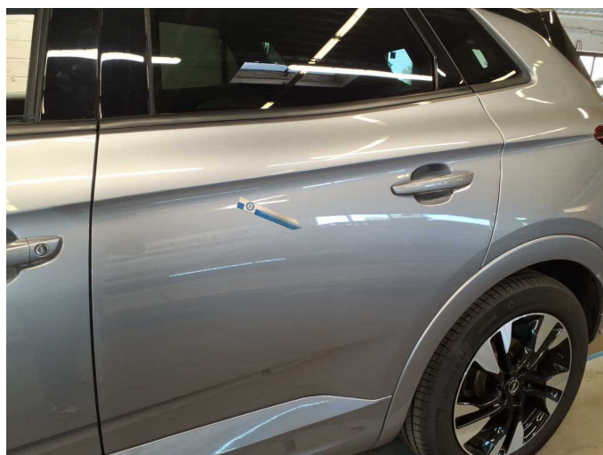
Beschädigung 3: Tür hinten links: Tür - Kratzer - lackieren
