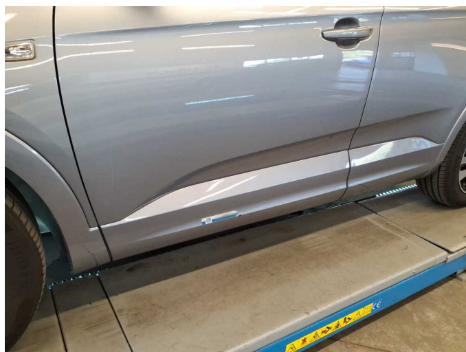
Beschädigung 2: Verkleidungen/Abdeckungen: Türverkleidung vorn links - Kratzer - Smart Repair
