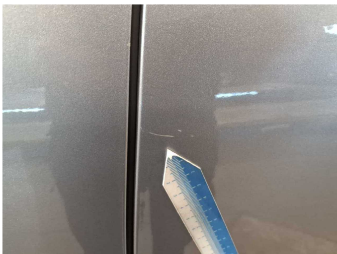
Beschädigung 3: Tür hinten links: Tür - Kratzer - lackieren
