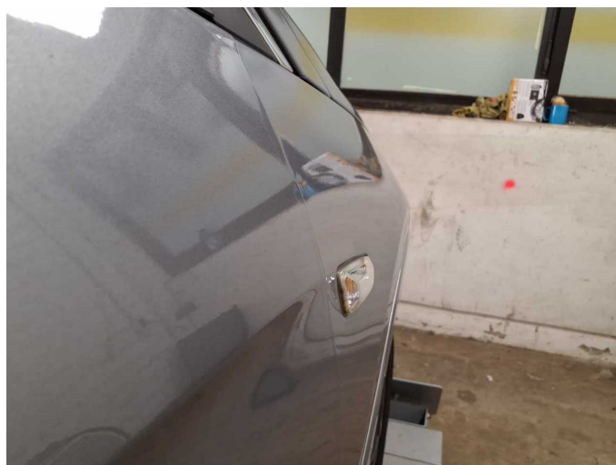
Beschädigung 1: Tür vorn rechts: Tür - Fehlstellung - einstellen/justieren
