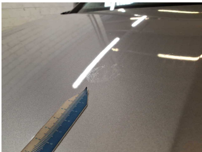
Beschädigung 4: Motorhaube: Motorhaube (Vogelkotverätzung) - Lackmangel - lackieren
