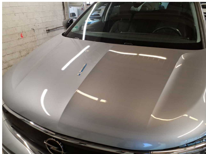
Beschädigung 4: Motorhaube: Motorhaube (Vogelkotverätzung) - Lackmangel - lackieren
