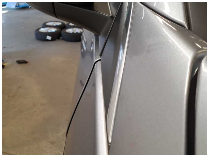
Beschädigung 1: Tür vorn rechts: Tür - Fehlstellung - einstellen/justieren
