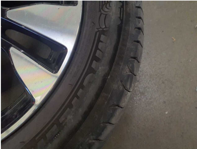
Damage 5: 2nd wheel set: 1 tyre (Reifen Drucklos & Außenflanke verschlissen) - Worn - Replace
