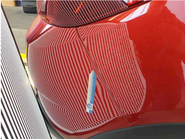
Beschädigung 1: Stossfänger hinten: Stossfänger hinten rechts - verformt - instandsetzen und lackieren
