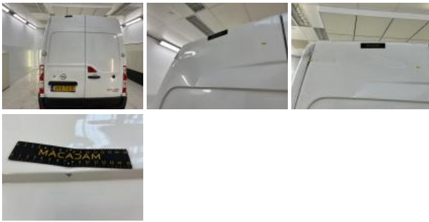
Achterdeur R, Vervormd / Geforceerd, Herstellen en spuiten (compleet)
