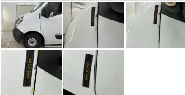
Zijwand V L (Bedr.w), Kras(sen), Herstellen en spuiten (compleet)
