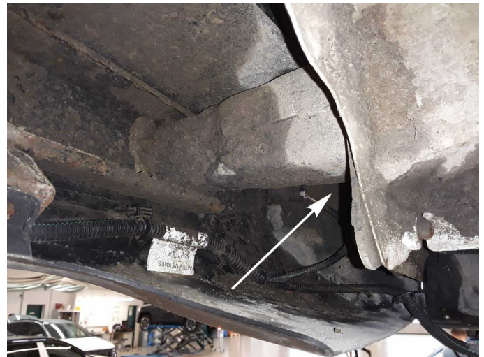
Damage 8: Rear bumper: Rear bumper (unpainted) (Mehrkosten können entstehen) - Deformed - Replace
