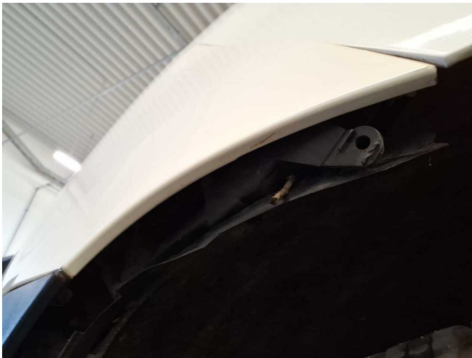
Damage 16: Front bumper: Front bumper (Unterteil + Verstärkung links) - Broken / torn - Replace
