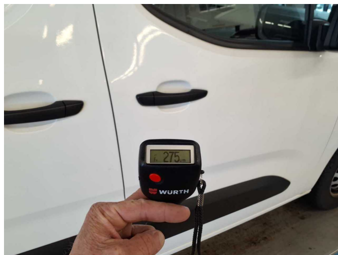
Door - front right side: 275 µm
