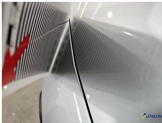
1. Motorhaube Verformt (leicht)
