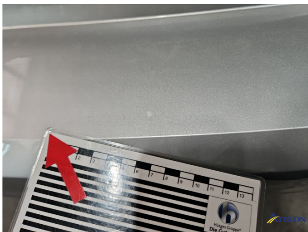
6. Stoßfänger Hinten Kratzer
