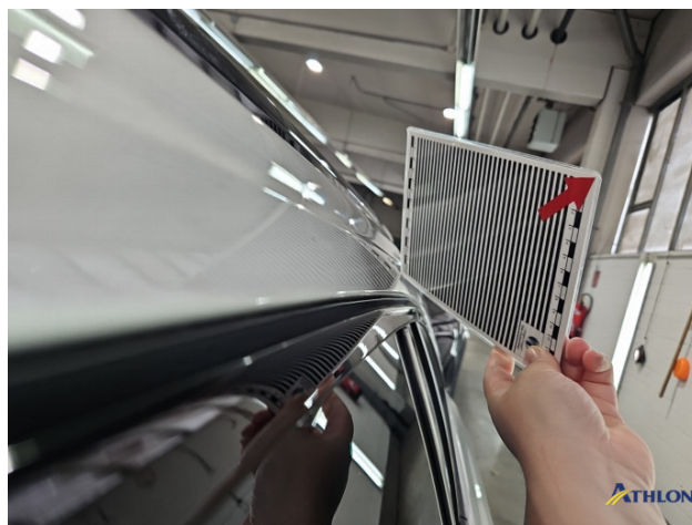
4. Dachrahmen - Links Verformt (leicht)
