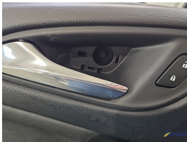
13. Türverkleidung Abdeckung Fehlt
