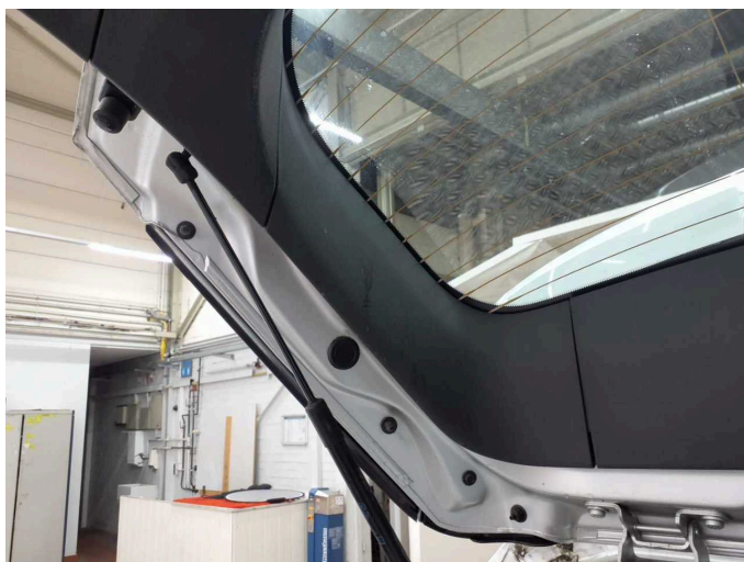
Beschädigung 1: Verkleidungen/Abdeckungen: Heckdeckel, Innenverkleidung - beschädigt - erneuern
