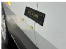
Bumper A sierlijst, Kras(sen), Vervangen en spuiten
