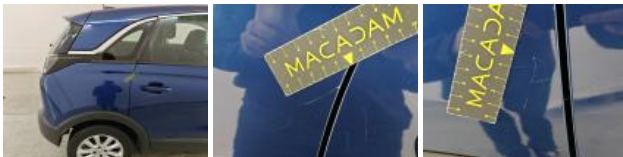
Porte ARD, Griffe(s), LI - Réparer et peindre (complet)
