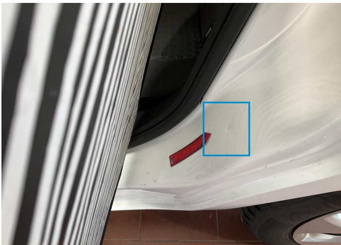
6. Door Edge / Back Left Bodywork / Dent / Dent -
