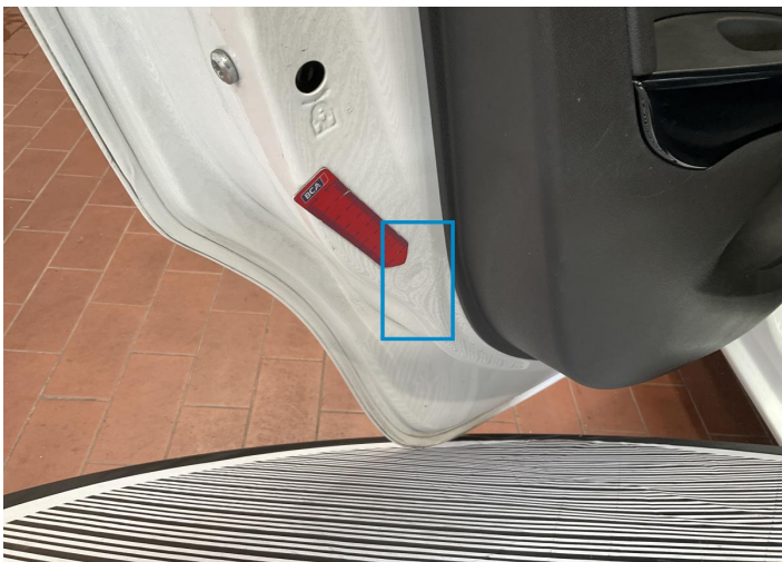
5. Door / Back Left Bodywork / Dent / Dent -
