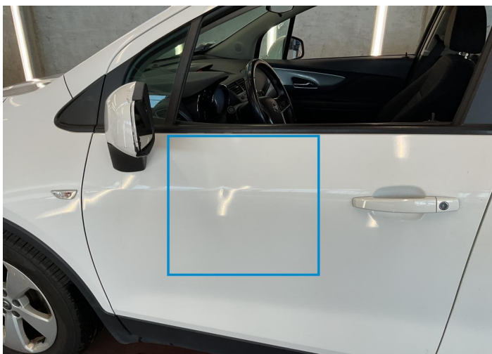
18. Door / Front Left Bodywork / Dent -
