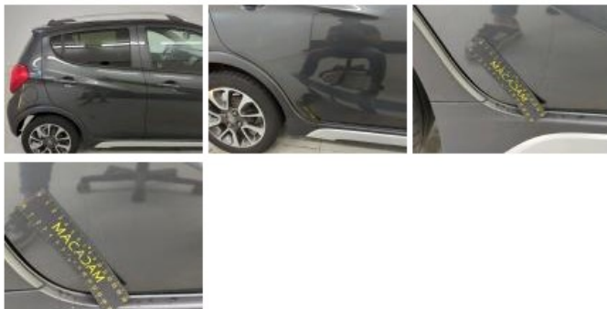
Velg A R alu, Roest / Corrosie, Herstellen en spuiten (compleet)
