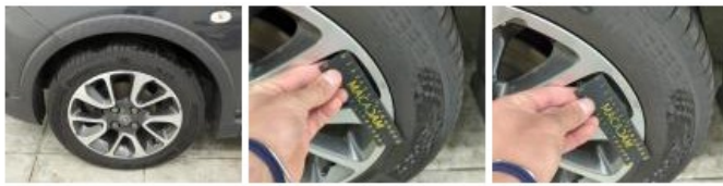
Velg A L alu, Roest / Corrosie, Herstellen en spuiten (compleet)
