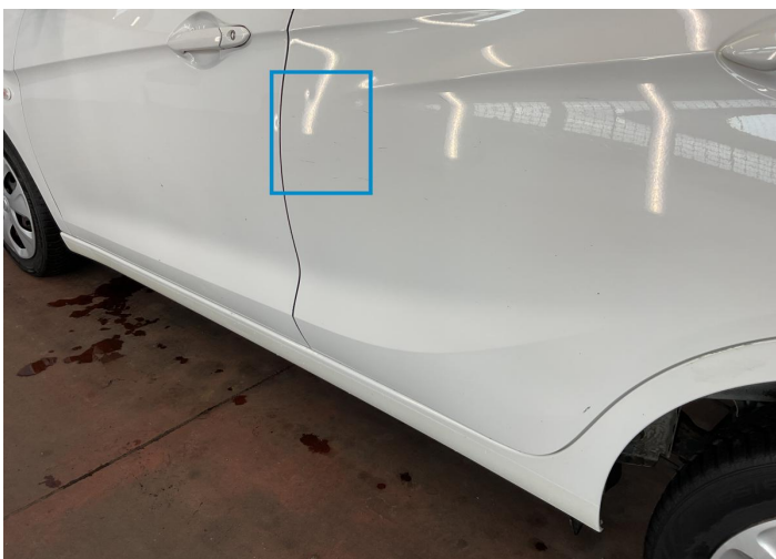
8. Door / Back Left Bodywork / Dent -
